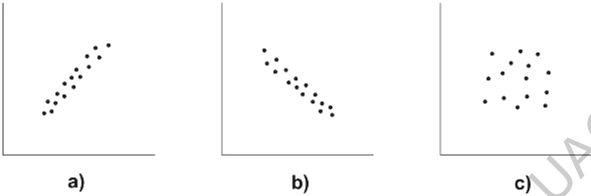
Figura 2.5 Coeficiente de correlación. a) Cercano a +1, b) cercano a -1, c) cercano a 0.
