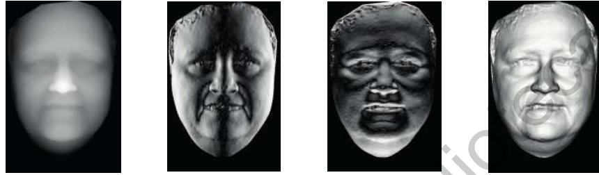
Figura 2.10: De izquierda a derecha, imagen de rango original de la base de datos Texas 3DFRD , imagen normal del componente x , imagen normal del componente y , imagen normal del componente z
