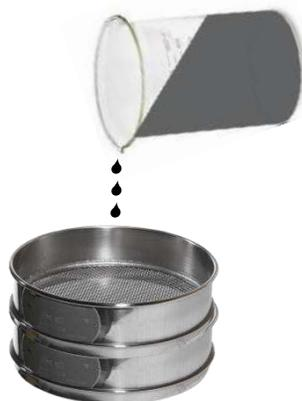
**Figura 2. 11 Vertido de emulsión asfáltica en malla**
