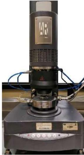
**Figura 2. 2 Reómetro de corte dinámico**
