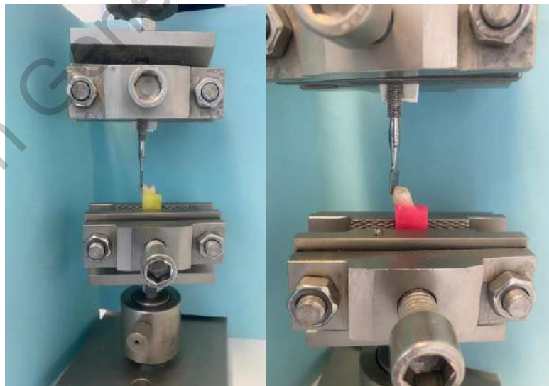
Fig. 4. Desprendimiento de los brackets con la maquina universal de pruebas CMS Metrology modelo WDW-5Y a una velocidad de crucero de 1 milímetro/minuto.
