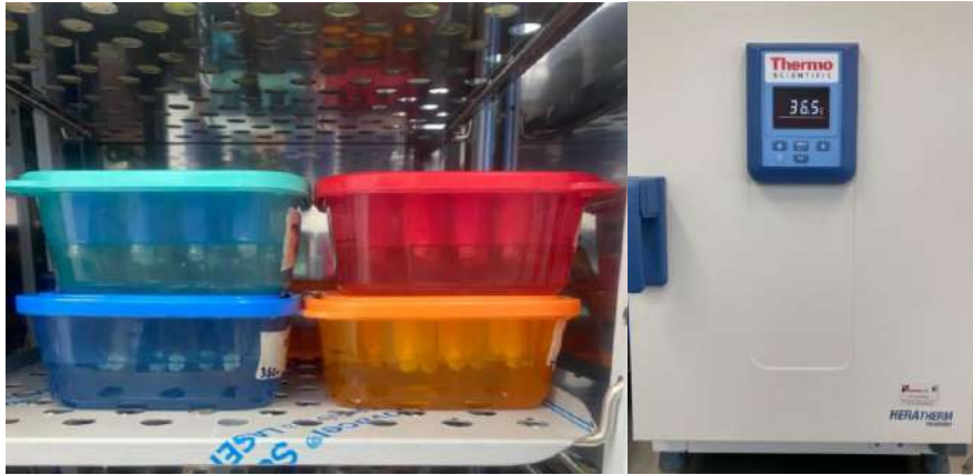
Fig. 3. Almacenamiento de los grupos experimentales en la incubadora Thermo Scientific Heratherm Incubator a 36.5 grados centígrados.
