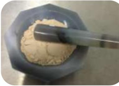
**Figura 9. Trituración de muestras en mortero de ágata.**
