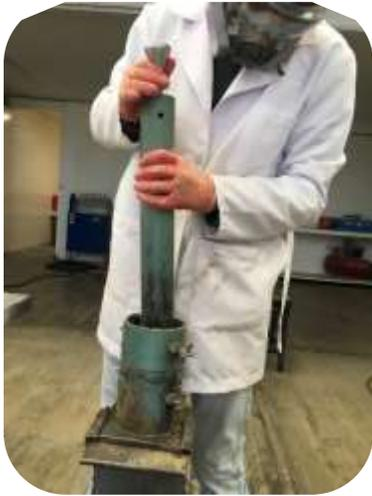
**Figura 30. Peso volumétrico seco máximo.**
