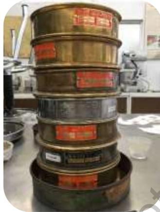
**Figura 25. Granulometría agregado grueso.**
