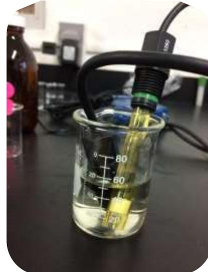
**Figura 23. Medición de pH, temperatura, conductividad y sólidos disueltos.**
