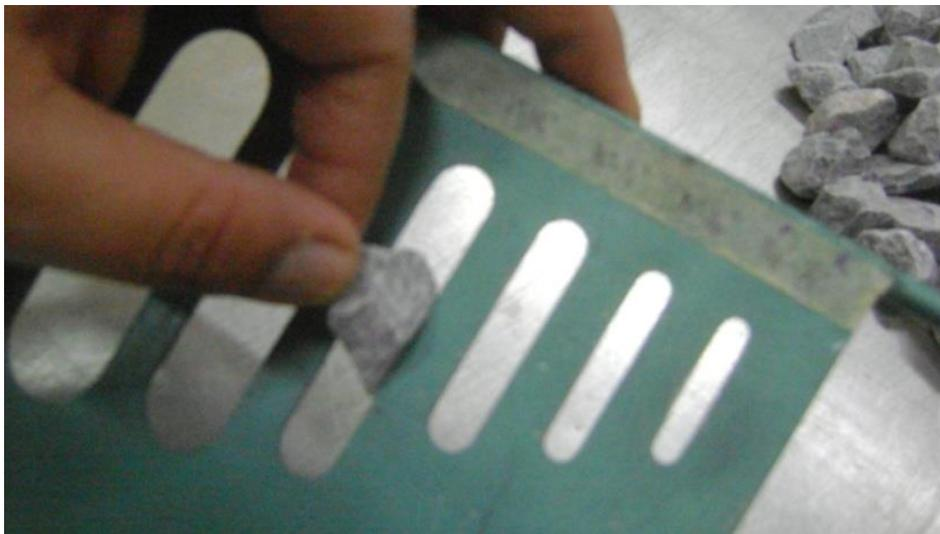
Figura 3.10 Calibrador de espesores
