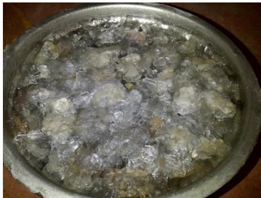
Figura 3.14 Prueba de sanidad (intemperismo acelerado)
