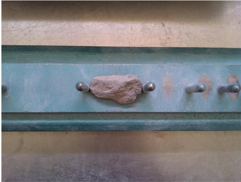
Figura 3.11 Calibrador de longitudes
