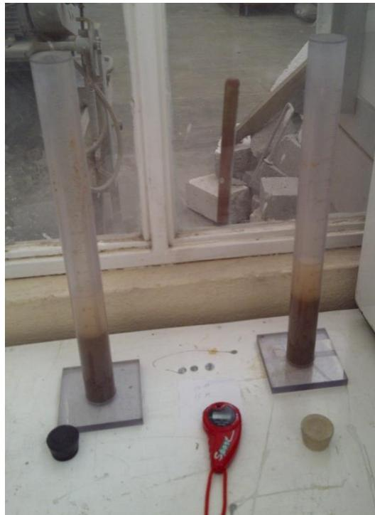
Figura 3.13 Prueba de equivalente de arena
