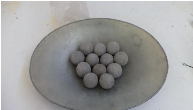
Figura 3.8 Esferas de hierro fundido
