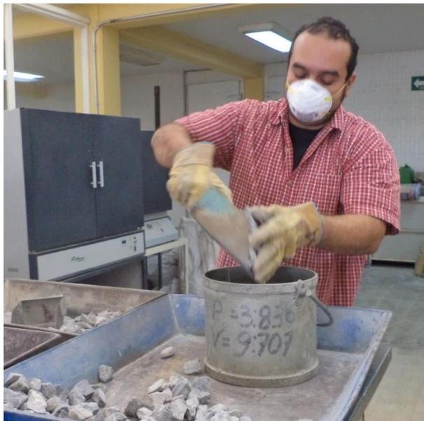
Figura 3.6 Peso volumétrico de la grava
