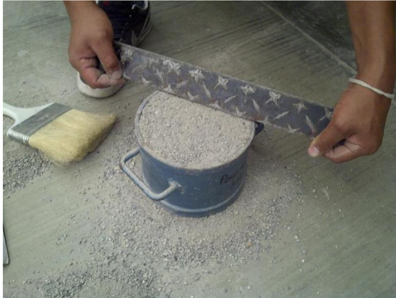
Figura 3.7 Peso volumétrico de la arena
