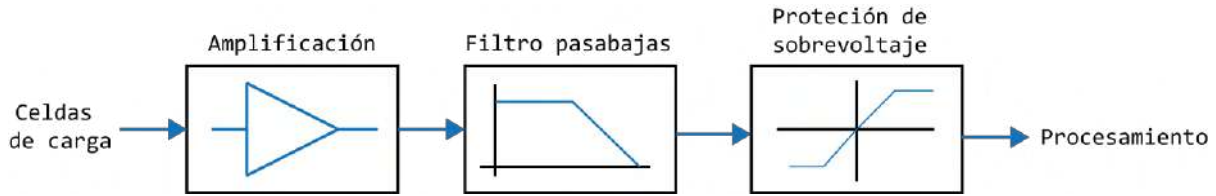
Figura 4.10: Diagrama simplificado de la etapa electrónica.
