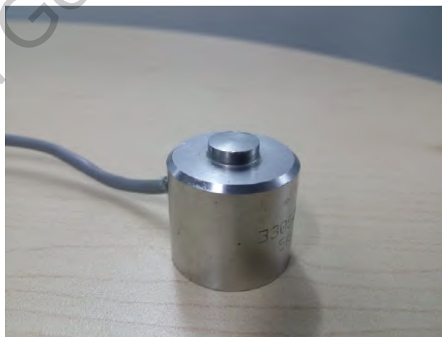
Figura 4.8: Celda de carga de botón Omega LM304-5K
