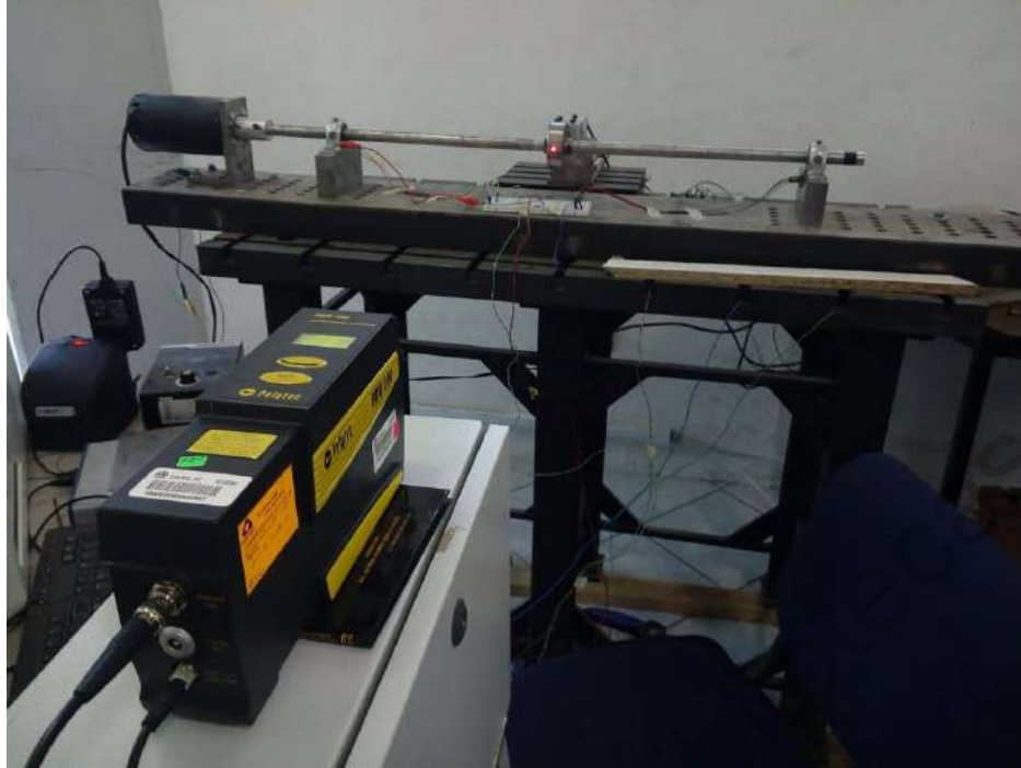
Figura 4.17: Prueba de desbalanceo con vibrómetro láser Polytec PDV 100
