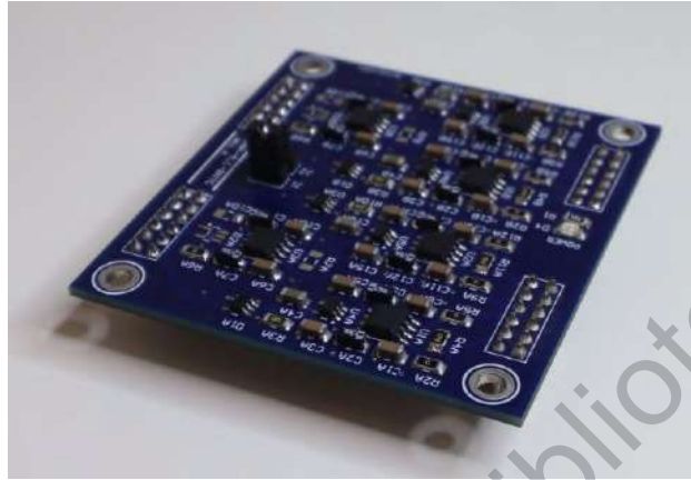
Figura 5.5: Fotografía de la tarjeta de instrumentación INA-4LC-8NTC.
