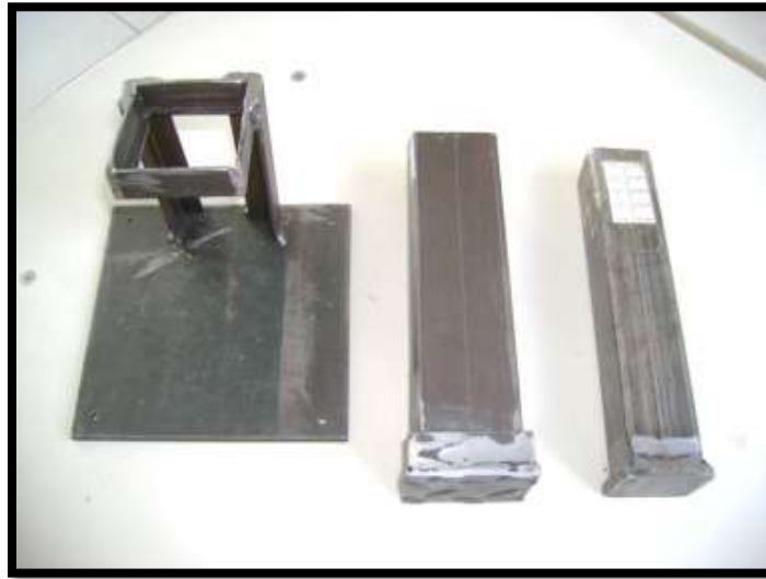
Figura III.6 Molde para especímenes remoldeados cúbicos
