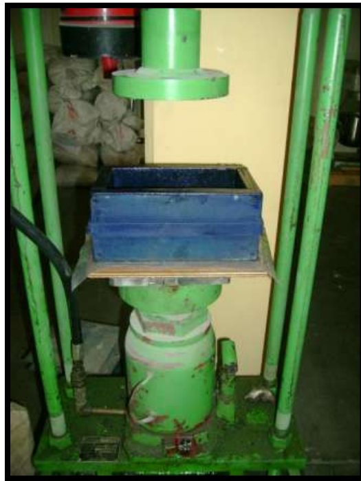
Figura III.11 Aplicación de la energía de compactación en las piezas de mampostería
