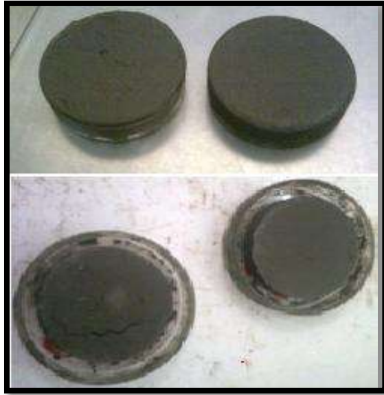
Figura A.11 Arcilla en cajas de Petri antes y después del secado
