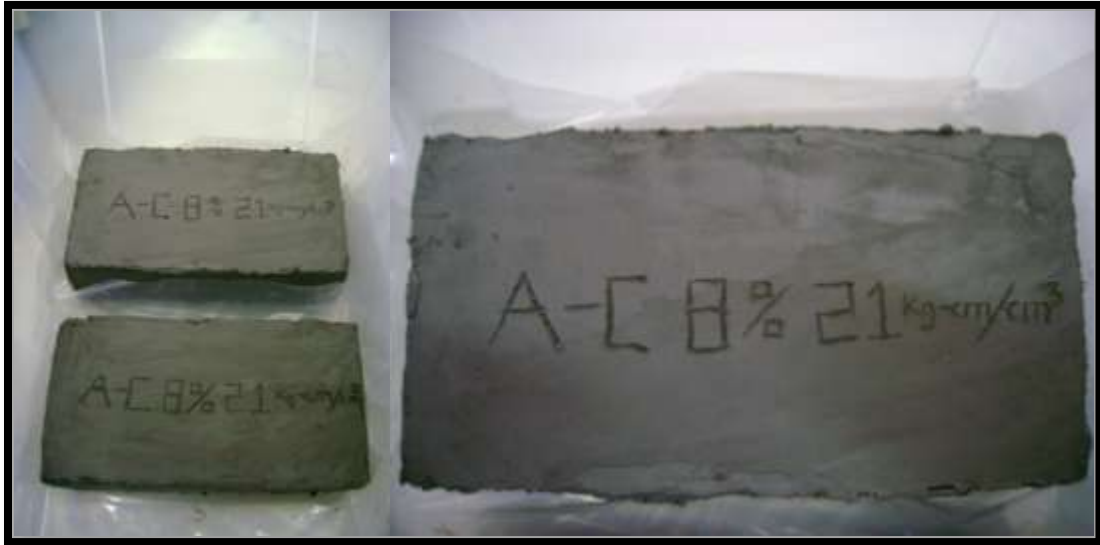
Figura III.12 Piezas de mampostería hechas con arcilla y con 8% de cal.
