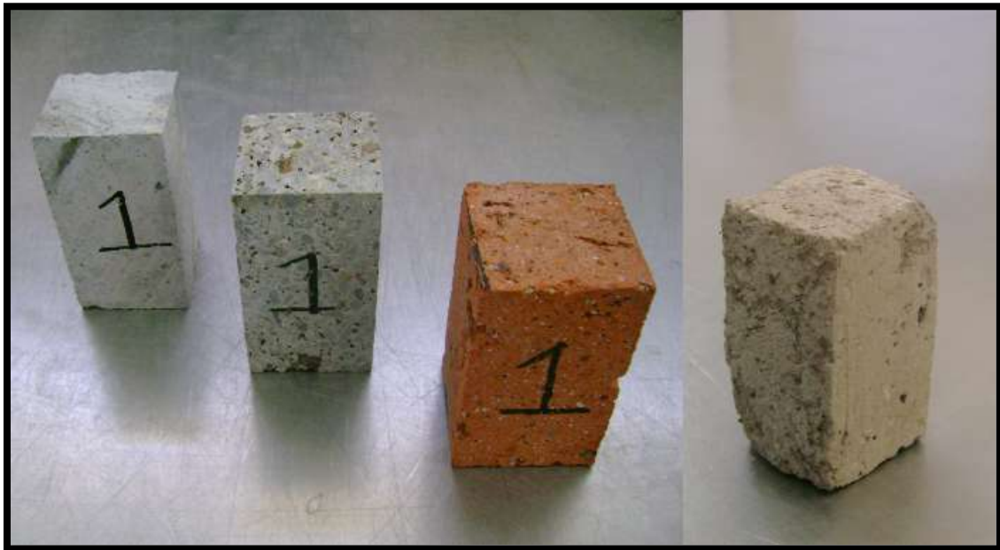
Figura III.8 Probetas con sección de 50 mm y altura de 90 mm labradas de piezas de mampostería
