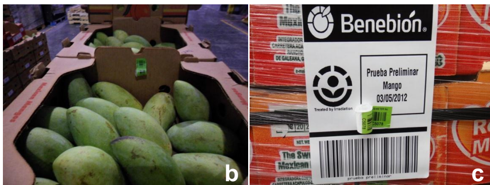
Figura 22. Dosímetros. a) Distribución de dosímetros de alanina (en color verde) dentro y fuera de las cajas de frutos que conformaron la tarima, b) Dosímetro de alanina ubicado dentro de la caja. c) Dosímetro de alanina.
