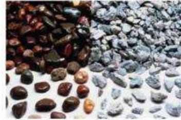
Figura 2-6. Agregados Gruesos (Piedra de río y triturada)
