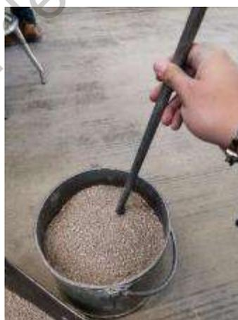
Figura 3-5. Proceso de apisonamiento de la arena
