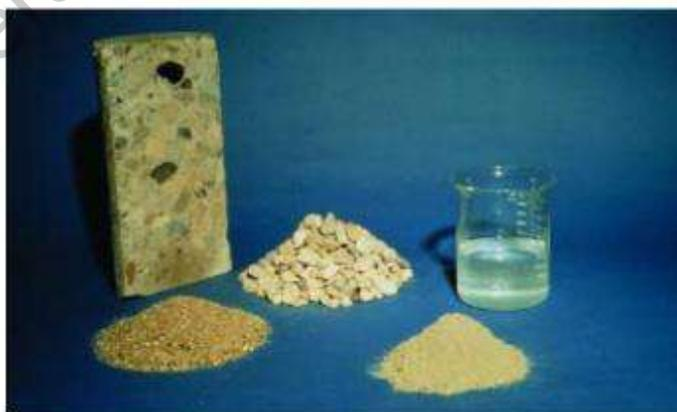
Figura 2-4. Componentes del Concreto Hidráulico.
