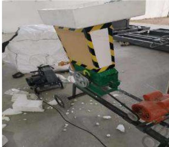
Figura 3-19. Máquina utilizada para el proceso de trititación.
