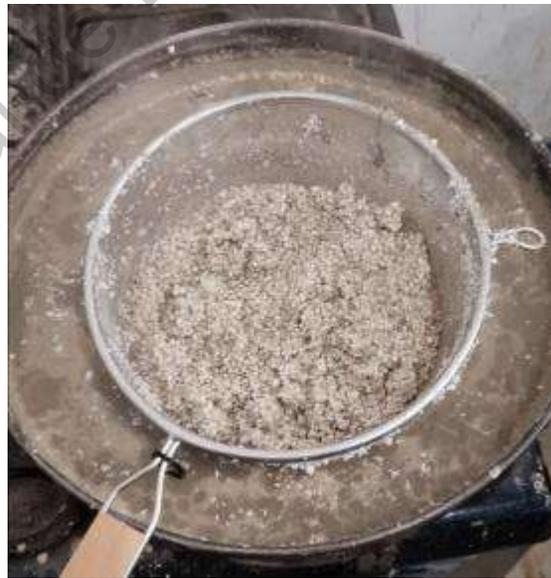
Figura 3-20. Proceso de recubrimiento de gránulos de EPS con Lechada 1:8.
