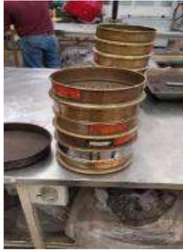
Figura 3-3. Tamices para ensayo de granulometría de agregado fino.
