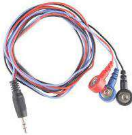
Figura 6.6. Cables para electrodos.
