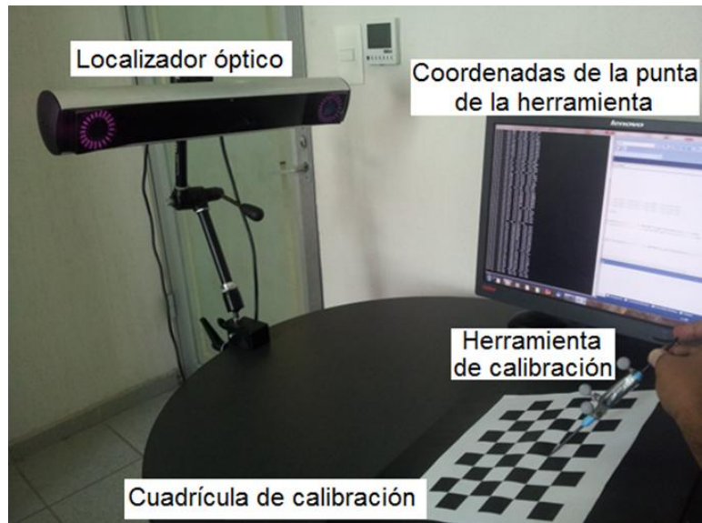
Figura 19. Configuración para la extracción de esquinas del tablero de calibración con el localizador óptico.
