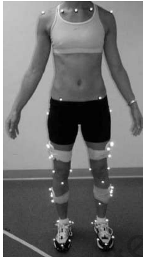
Fig. 3.8 Captura de los marcadores reflejantes con luz infrarroja (Hafer et al., 2015).
