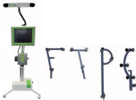
Figura 2.10. A la izquierda: Sistema de navegación ART con guía robótica de corte Praxim. A la derecha: Marcadores con material retro-reflejante.
