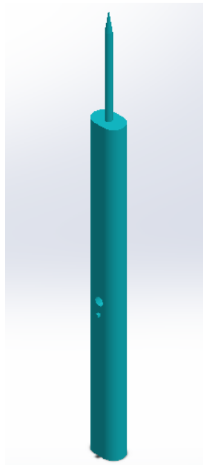
Diseño CAD de la herramienta para montar marcadores, realizar la calibración respecto al localizador óptico y realizar pruebas de navegación.
