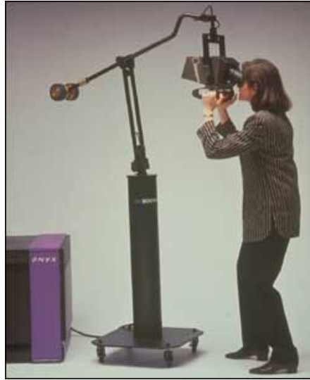
Ejemplo de un dispositivo localizador mecánico desarrollado por los laboratorios Fake Space.
