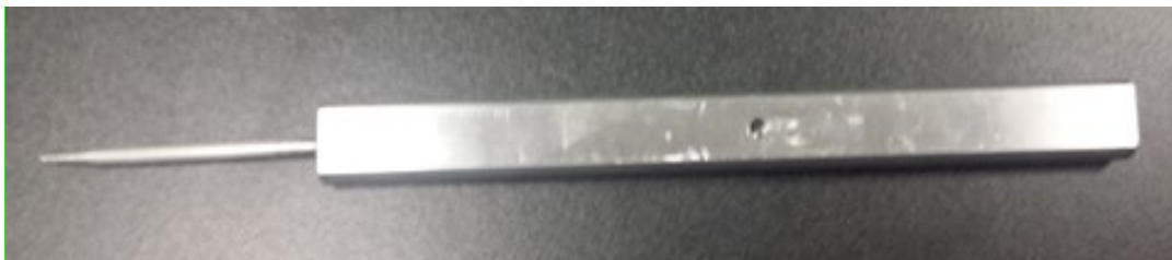
Figura 3.14. Herramienta apuntadora construida.
