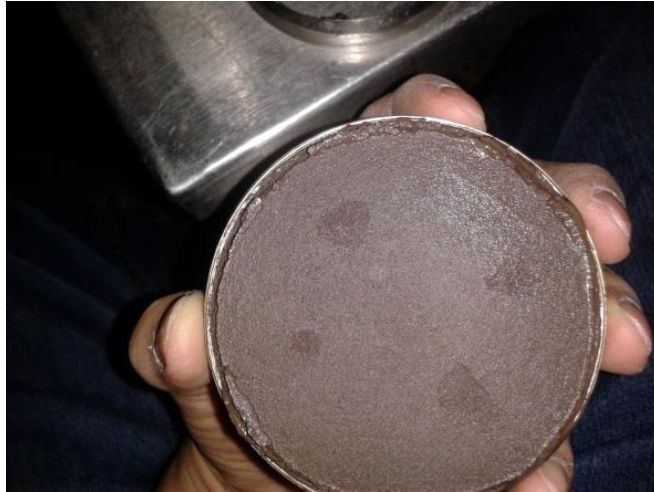
FIGURA 5.10 (c). Parte inferior de muestra saturada con 0.9% de volumen retirado.
