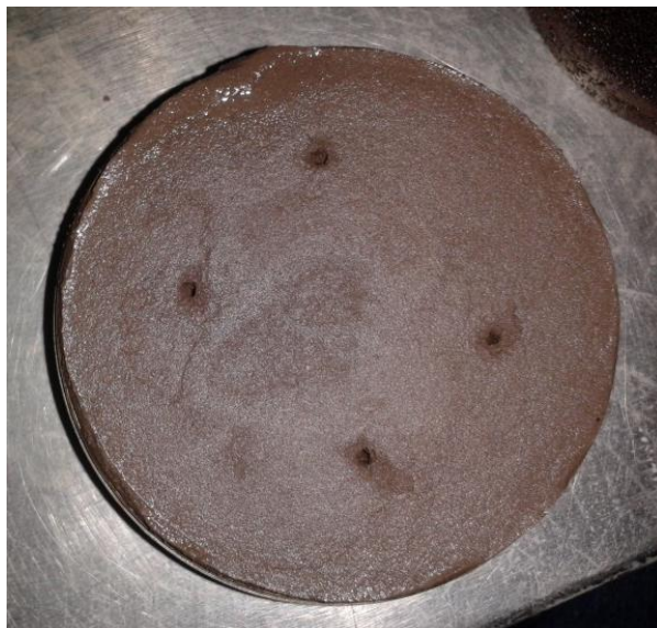
FIGURA 5.10 (b). Parte superior de muestra saturada con 0.9% de volumen retirado.
