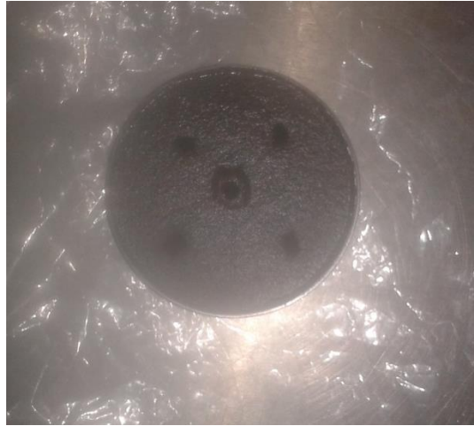
FIGURA 5.11. (b) Parte superior de muestra saturada con 6.6% de volumen retirado.
