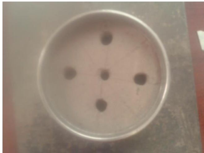
FIGURA 5.11. (a) Parte superior de muestra con 6.6% de volumen retirado sin saturar.
