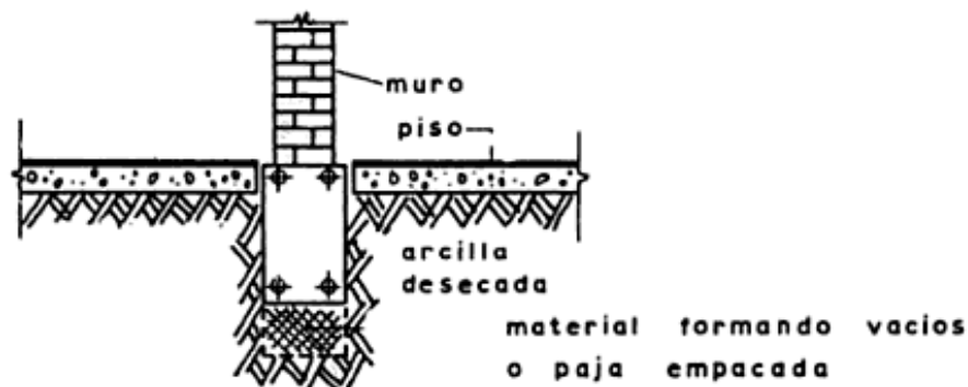
FIGURA 2.2. Viga con vacíos en parte inferior (Crespo, 2004).
