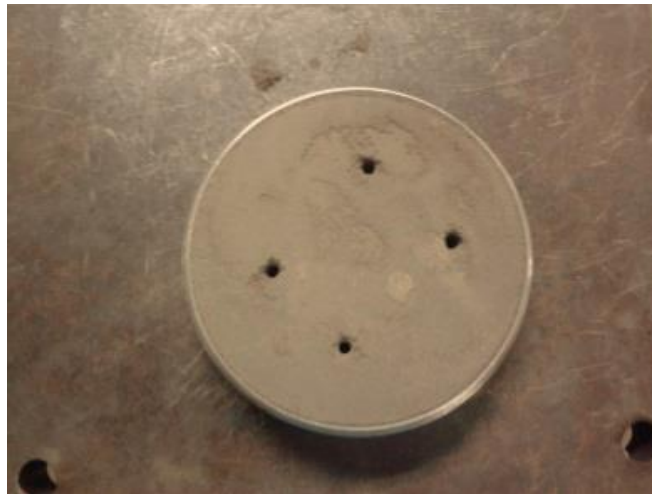
FIGURA 5.10 (a). Muestra con 0.9% de volumen retirado sin saturar.
