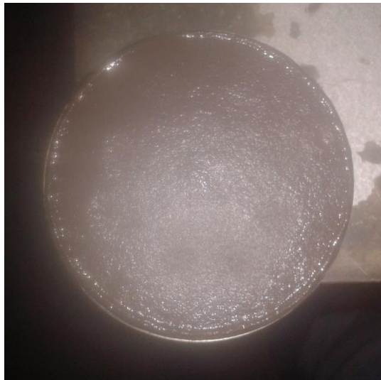
FIGURA 5.12. (c) Parte inferior de muestra saturada con 13.8% de volumen retirado.
