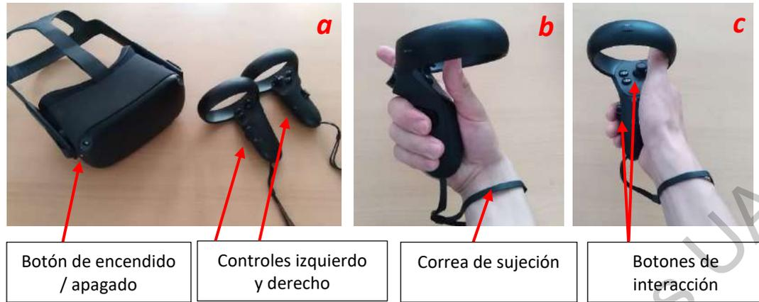
**Figura 4.1** Sistema Oculus Quest: casco y controles
