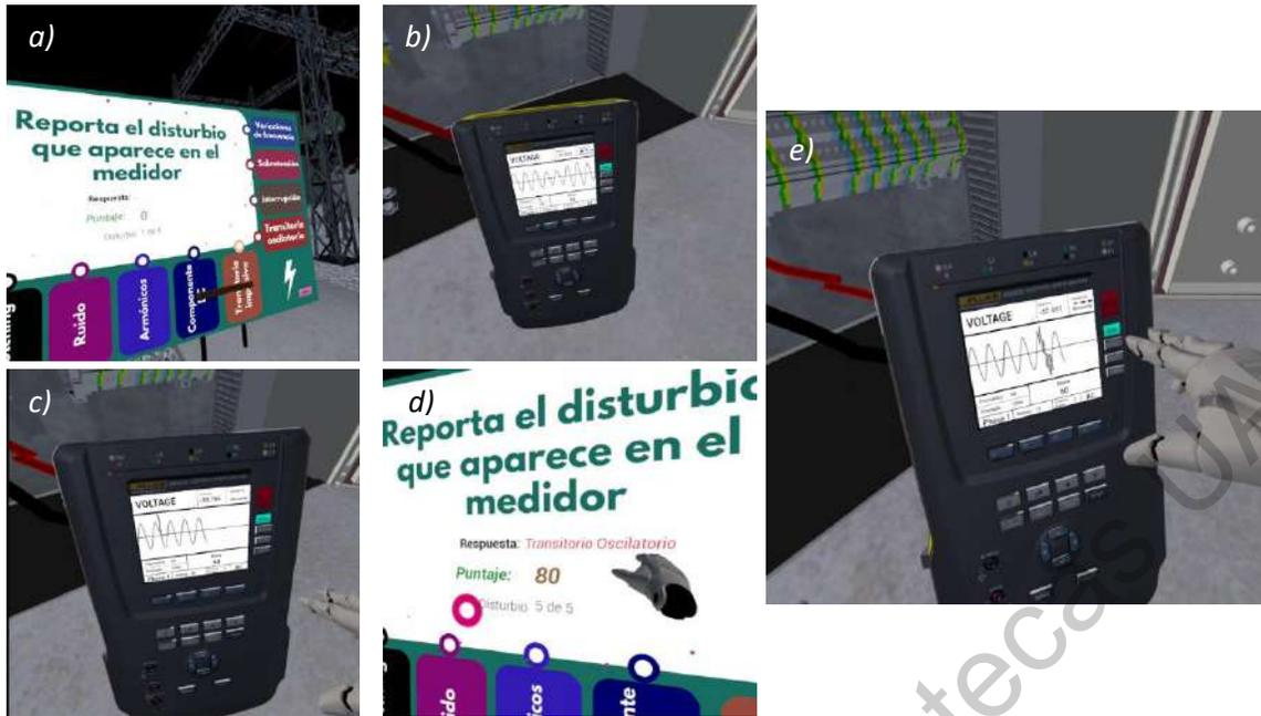
Figura 4.24 Reconocimiento de disturbios eléctricos inyectados en la subestación
