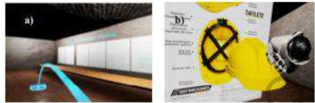
Figura 10. Sistema de RV, en a) Disparador de desplazamiento y dirección y b) Interacción con un caso de seguridad a través de las manos del usuario, que son simuladas por los controles del sistema OR.
