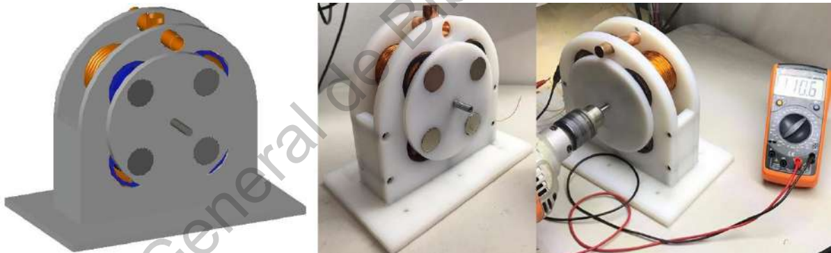
Figura 43. Comparación del modelado del diseño del generador con el físico y puesta en marcha.
