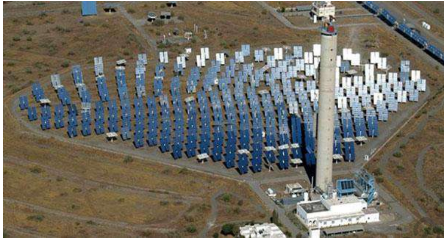
Figura 1. Central solar de torre central CESA-1 (Camacho et al., 2012).
