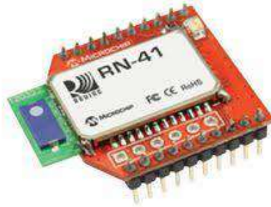
Figura 20. Módulo de comunicación Bluetooth RN41XVC-I / RM.
