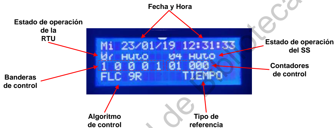
Figura 65. Datos que muestra la LCD de la unidad terminal remota.
