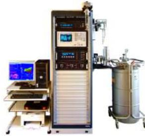
Figura 2.14: Espectrómetro dieléctrico de banda ancha NOVOCONTROL.
