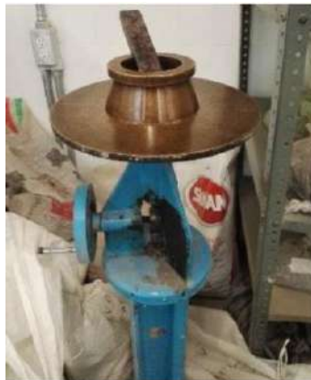
Figura 7 Mesa de Fluidez, cono de fluidez y pisón. (fuente propia)
