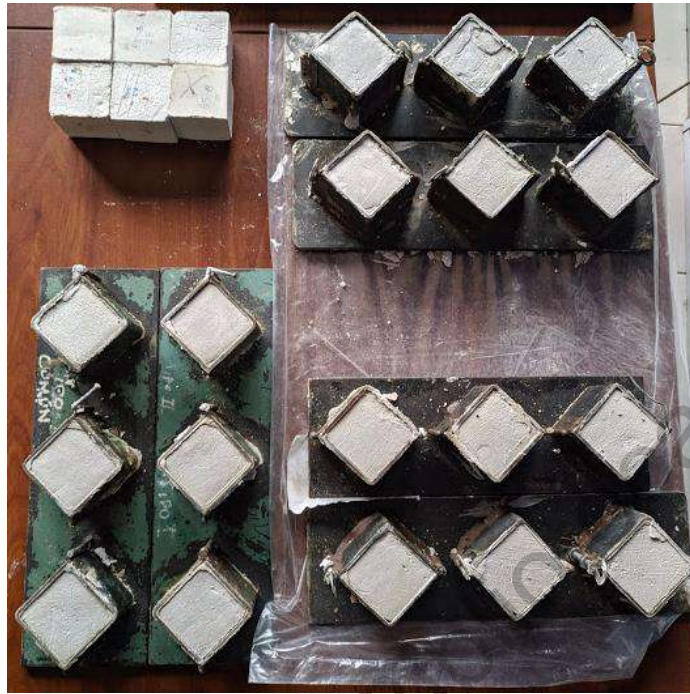
Figura 19 Ejemplo del primer lote de probetas cubicas.
