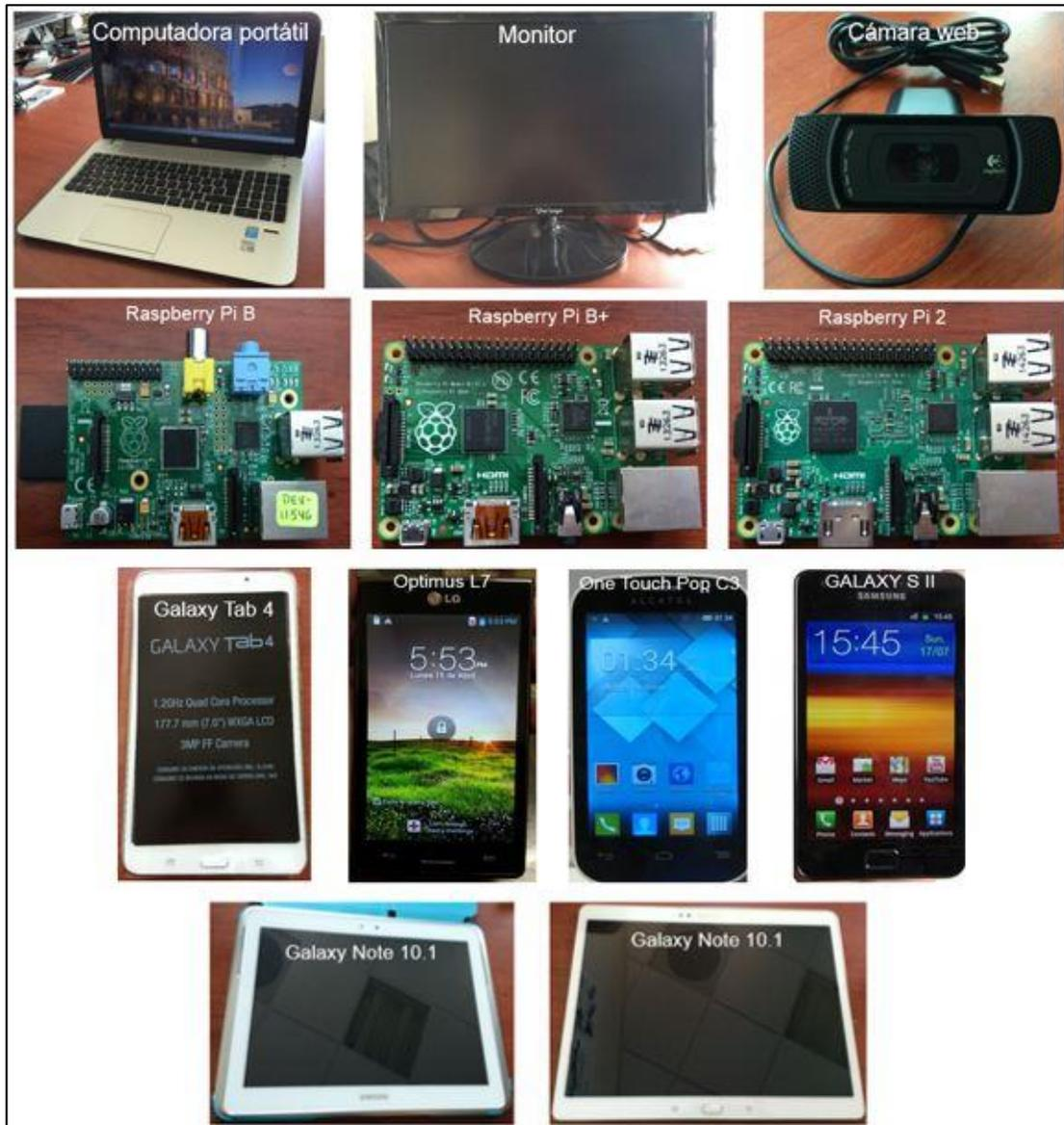
Dentro de la sección de pruebas se realizaron una serie de experimentos con diferentes dispositivos, el primero de ellos fue una computadora portátil ya que en esta primera etapa se implementó en Python el preprocesamiento de imágenes y el algoritmo SURF. Posteriormente se llevó a cabo una etapa intermedia de pruebas en tarjetas programables (Raspberry Pi) dado que estas presentan una arquitectura electrónica muy similar a la de los dispositivos móviles (Smartphone y Tablet).
