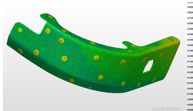
Fig. 103 Comparativo de una pieza fabricada en la máquina CNC con su respectivo modelo 3D.
