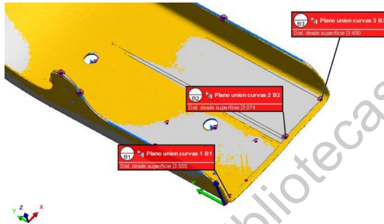
Fig. 68 Comparación entre el modelo 3D y alguna de las piezas productivas digitalizada.
