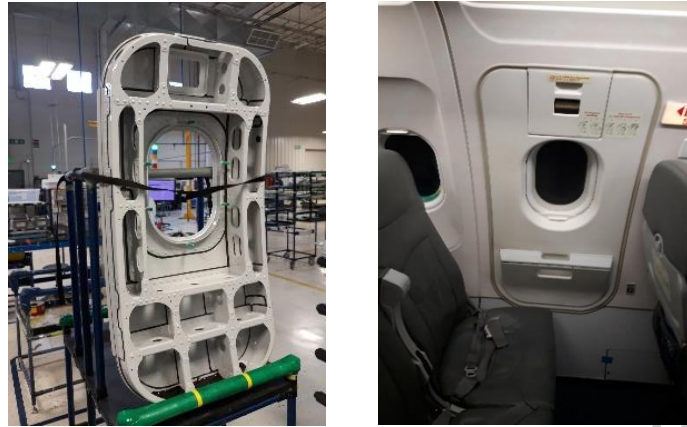
Fig. 5 Comparativo de la escotilla de emergencia (EEH) durante el proceso de producción y una vez ensamblada en el avión.
