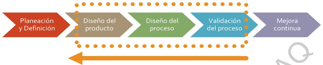
Fig. 32 Metodología planteada en realizar el APQP de una manera inversa, enfocándose en las tres fases intermedias de la metodología.
