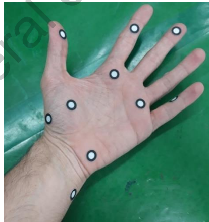
Fig. 62 Colocación de puntos de referencia ( targets ) a una mano para verificar la exactitud del método.
