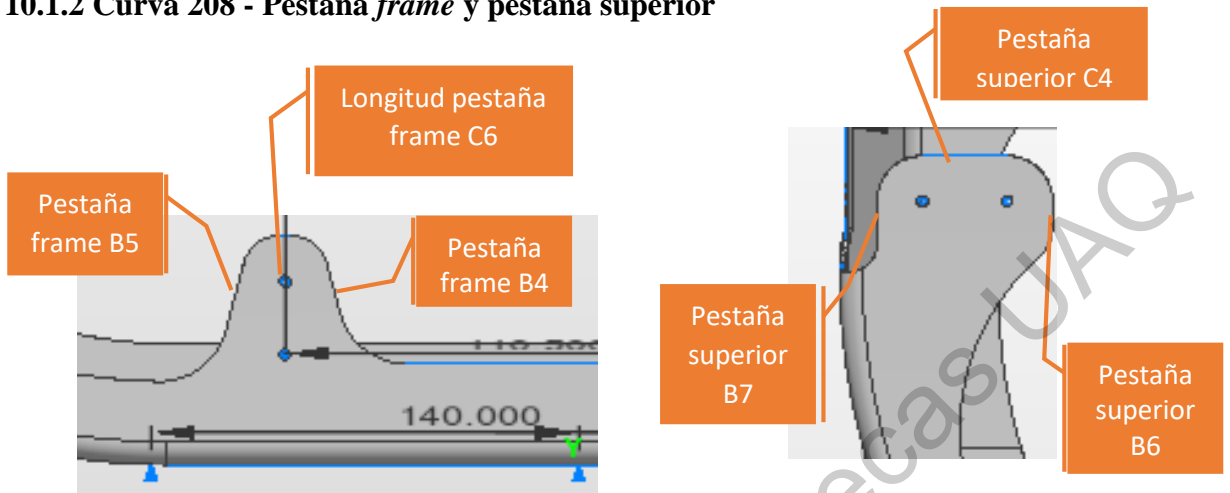
Fig. 70 Ubicación de las cotas Pestaña frame (B4, B5, C6) y pestaña superior (B6, B7, C4) mostrados en el modelo 3D.
