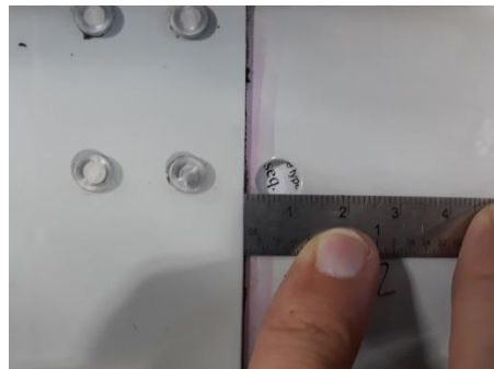
Fig. 69 Ejemplo de efecto por tener alguna de las cotas (A1, A2, A3) o (B1, B2, B3) por fuera de los límites de especificación. Fuente: Elaboración propia.
