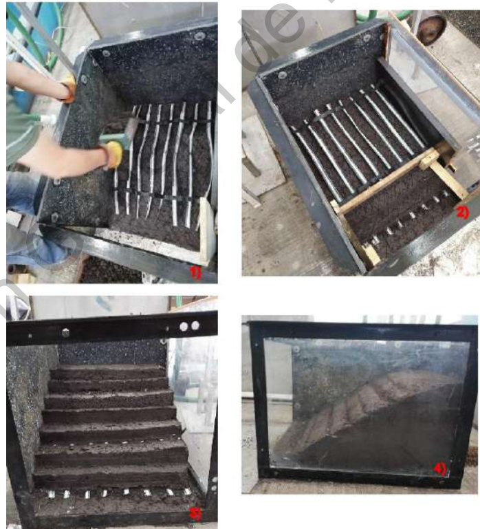
Figura 24.- Conformación de talud Con Refuerzo (CR01)
