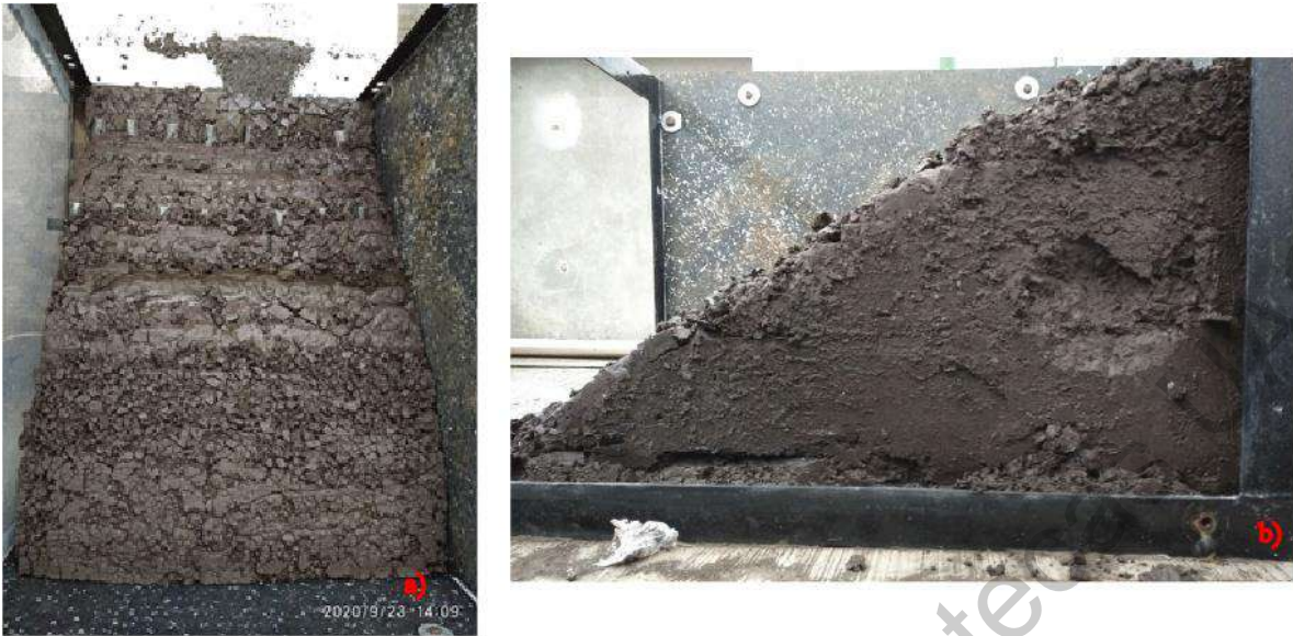
Figura 34.- Vista superior y lateral posteriores a 14ª tormenta en CR01
