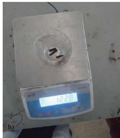
Figura 11.- Límite Plástico a) Esfera de 12 mm de diámetro b) Cilindros de 3mm de diámetro
