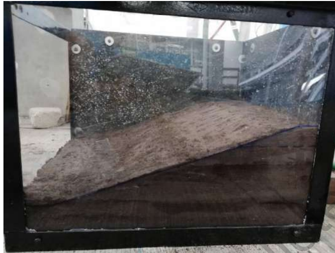
Figura 26.- Talud sin refuerzo (SR 1)
