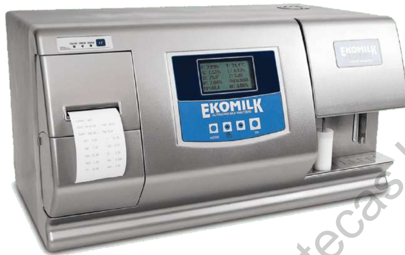
Figura 8 - Ekomilk TOTAL ®, analizador ultrasónico de leche (EON, 2020).
