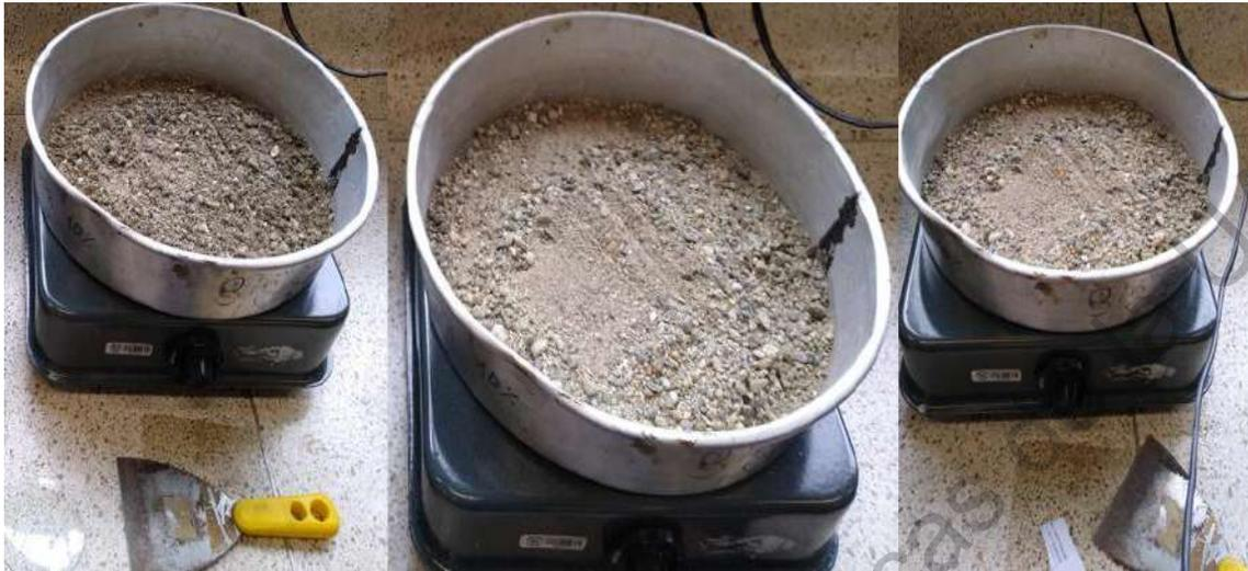
**Figura 3.13 Contenido de agua del agregado fino**
