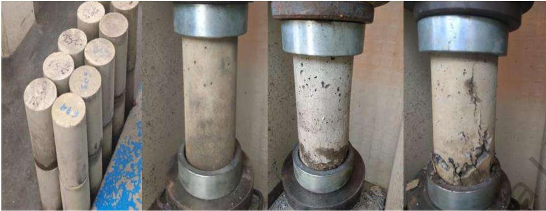
**Figura 3.19 Ensayo de resistencia a la compresión de concretos**
