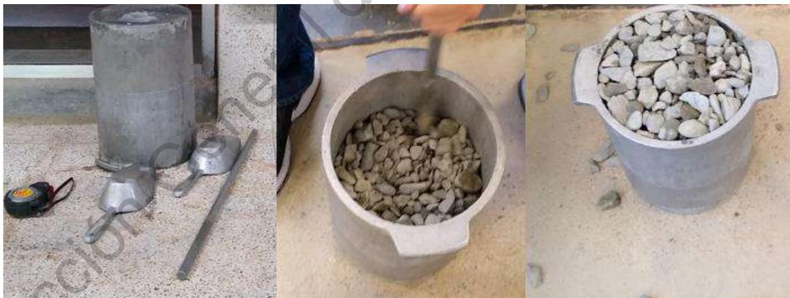
**Figura 3.8** Ensayo de masa volumétrica del agregado grueso
