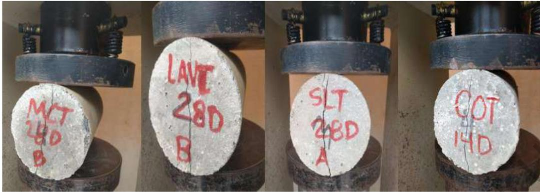
**Figura 3.21 Resistencia a la tensión por compresión diametral en concretos**
