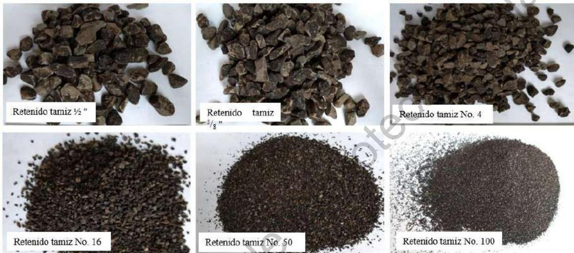
**Figura 4.5 Material RAP después de desgaste.**
