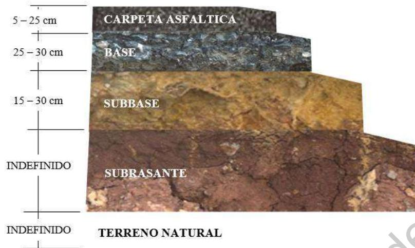
**Figura 2.1 Sección típica de un pavimento flexible**
