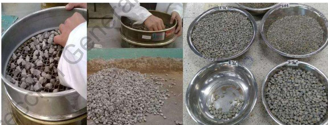
**Figura 3.7 Ensayo de distribución granulométrica del agregado grueso**
