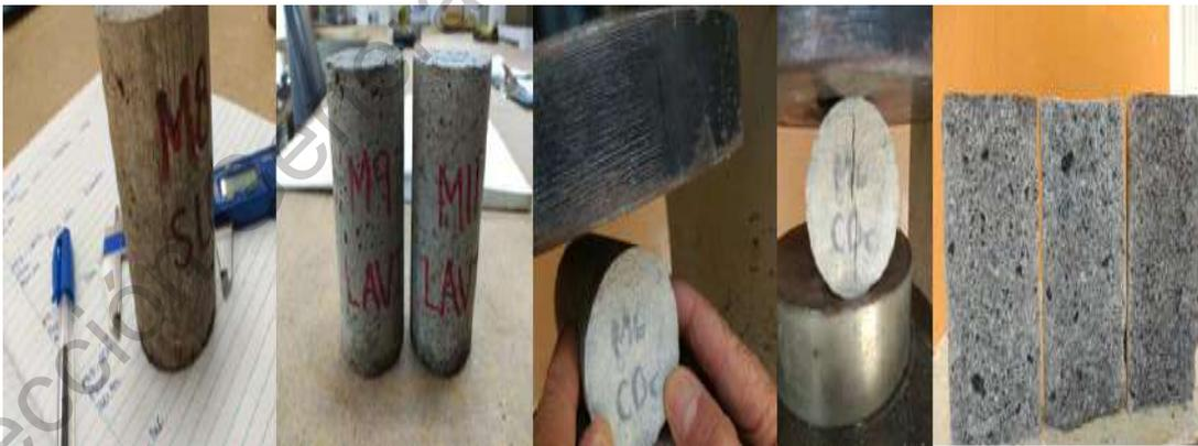
**Figura 3.20 Resistencia a la tensión por compresión diametral en morteros**
