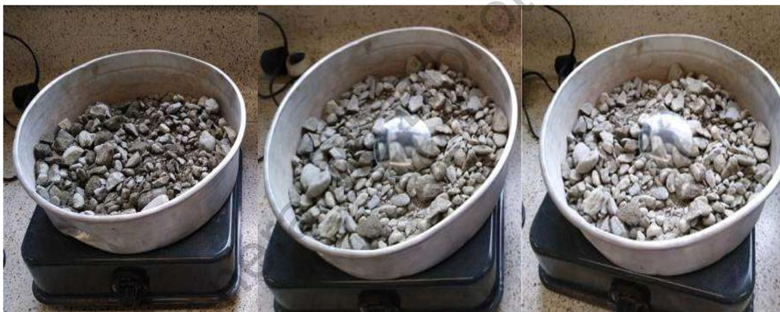
**Figura 3.9 Determinación del contenido de agua del agregado grueso**
