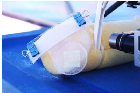
Imágen III.3. Equipo para la recolección de soplo. Izquierda: Drone quadcoptero Phantom 3®. Derecha: Lamina portaobjetos y caja Petri sujetas al drone. (Fotos: Carlos Domínguez)
