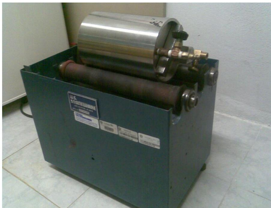
**FIGURA 5-3. Molino de bolas para mezclar los polvos a sinterizar.**
