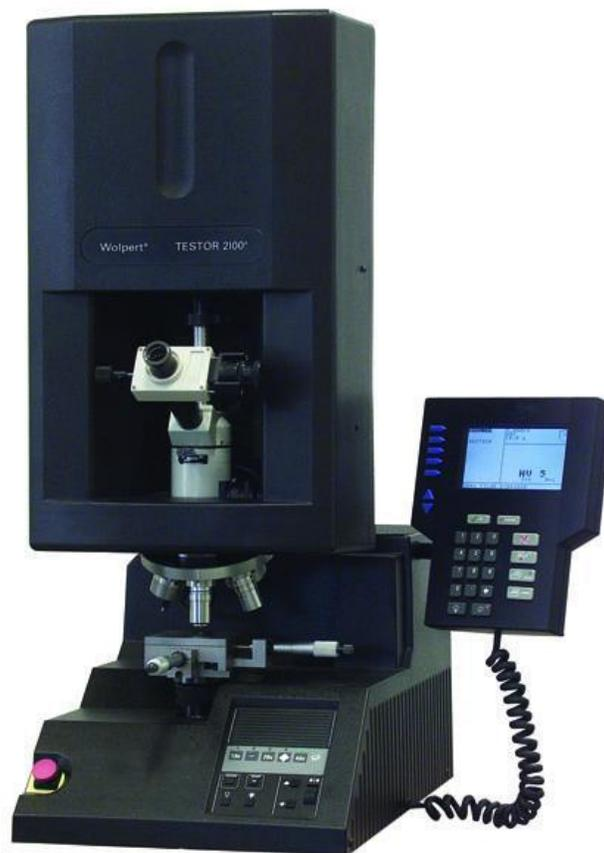
FIGURA 5-13. Equipo para prueba de micro-dureza Vickers.
