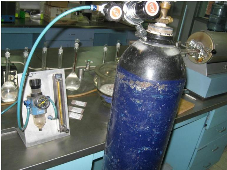
**FIGURA 5-9. Atmósfera de nitrógeno durante el proceso de sinterizado.**
