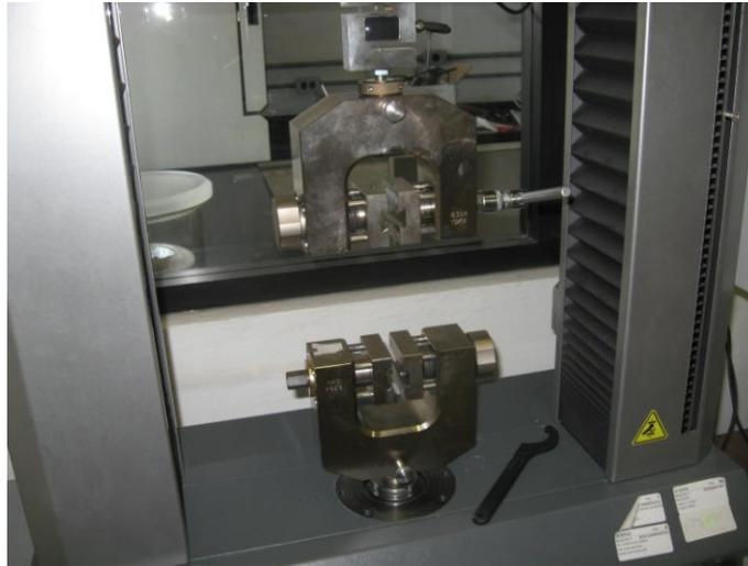
**FIGURA 5-11. Máquina universal para la prueba de resistencia a la tracción.**
