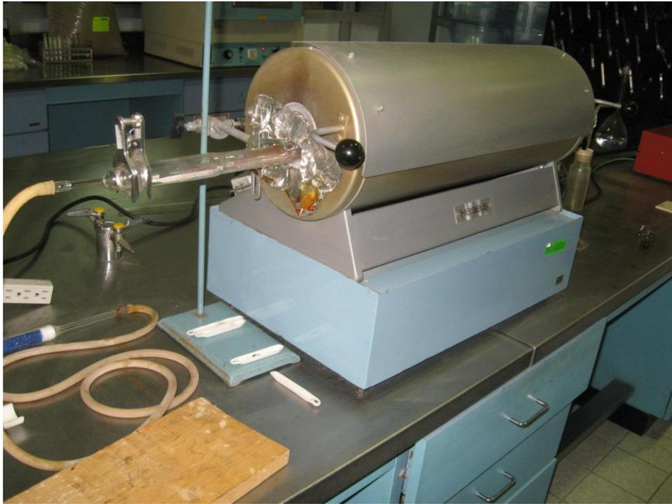
FIGURA 5-6. Horno tubular empleado para el proceso de sinterizado.
