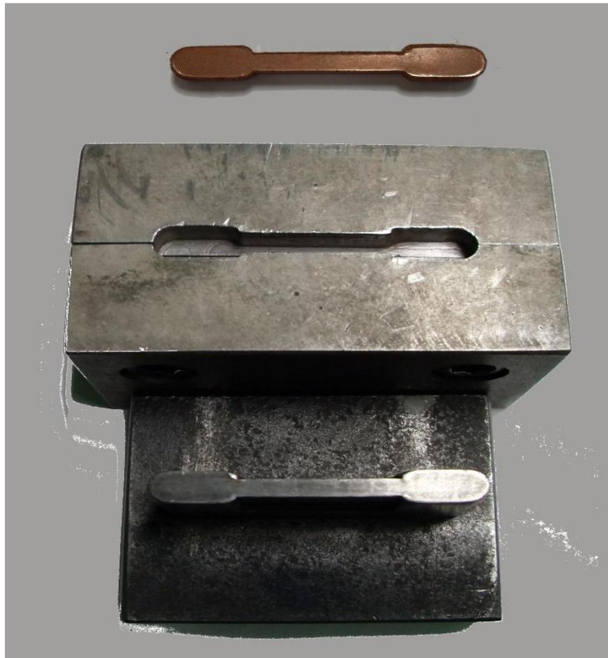
**FIGURA 5-4.** Dado de acero usado para compactar la mezcla de polvos.
