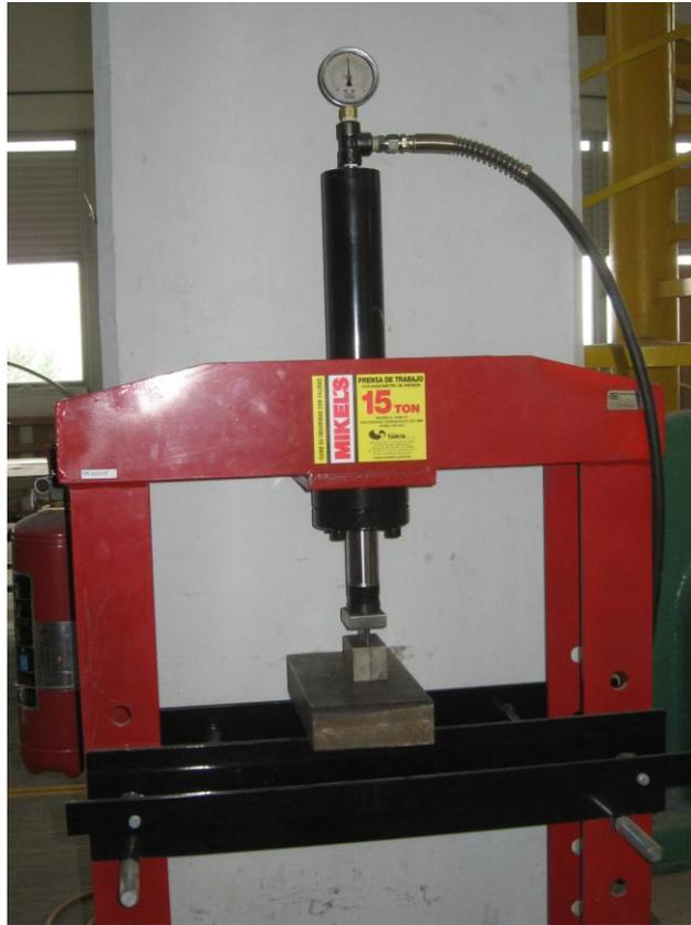
**FIGURA 5-5. Prensa hidráulica empleada para la compactación de las probetas.**
