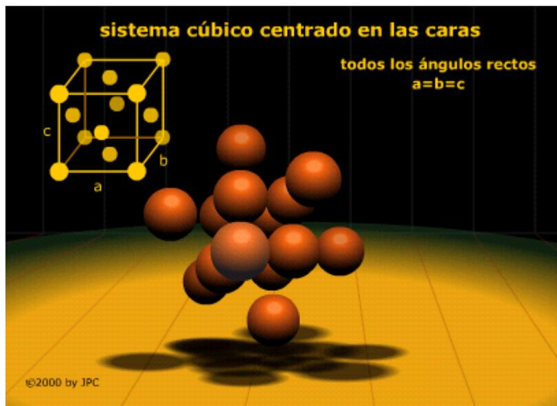
**FIGURA 4-2. Estructura cristalina del cobre.**
