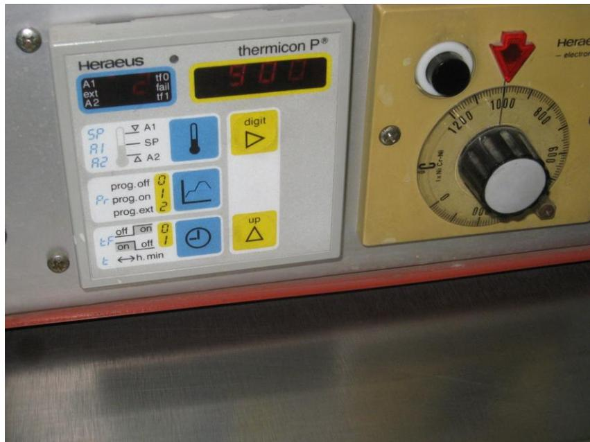
FIGURA 5-7. Control de temperatura del horno a 900°C.
