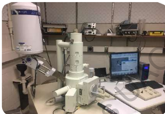
Figura 16 Microscopio SEM marca JEOL JSM-6060 LV.
