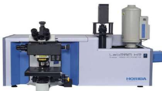
Figura 18 Espectrofotómetro Raman marca Horiba Scientific modelo LabRam HR.
