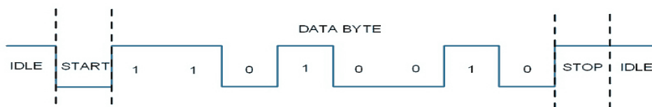
Figura 3. Estructura básica de la trama. (ElectronicWings, 2018).
