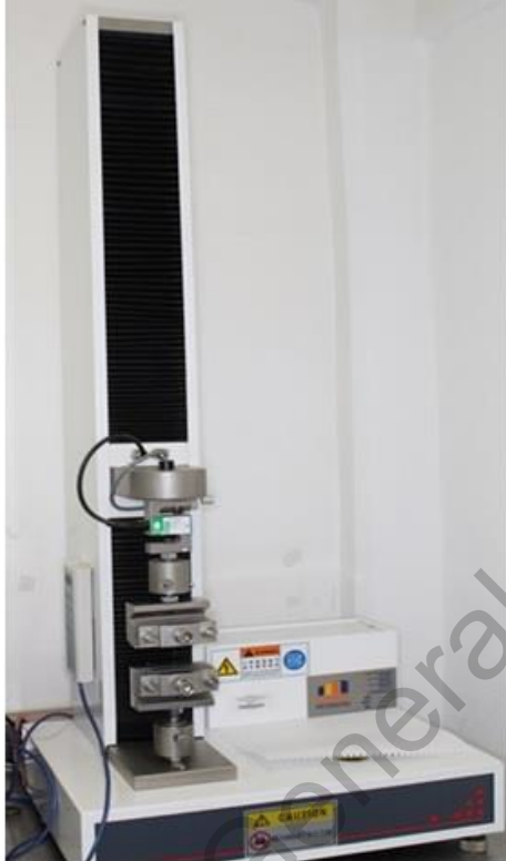
Fig.15 Maquina Universal de prueba marca CMS Metrology Modelo WDW-5Y
