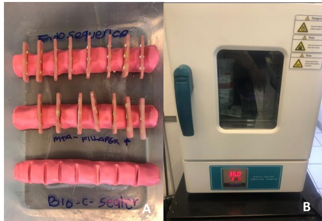
Figura 5. Almacenamiento de las muestras colocadas en contenedor de plástico, marcadas, sostenidas en plastilina con agua destilada A); Muestras colocadas en incubadora a 36°C B).
