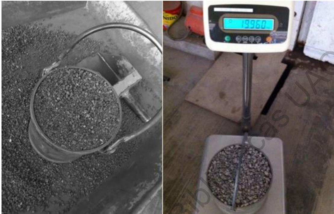
**Figura 3.8 Masa volumétrica compacta del agregado fino**
