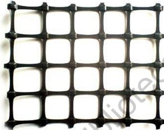
**Figura 2.16. Geomalla biaxial de polipropileno.**
