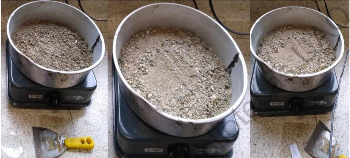
**Figura 3.9 Contenido de agua del agregado fino**
