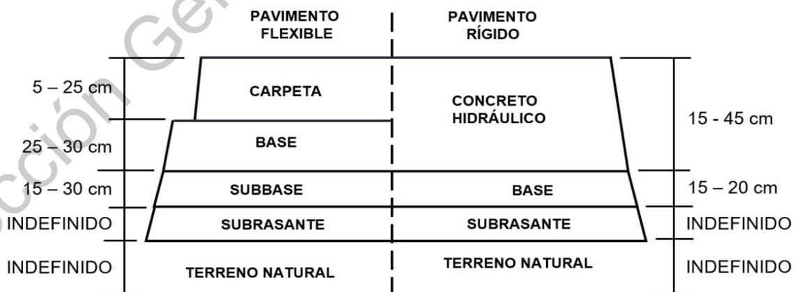
**Figura 2.5 Secciones típicas de los tipos de pavimentos**
