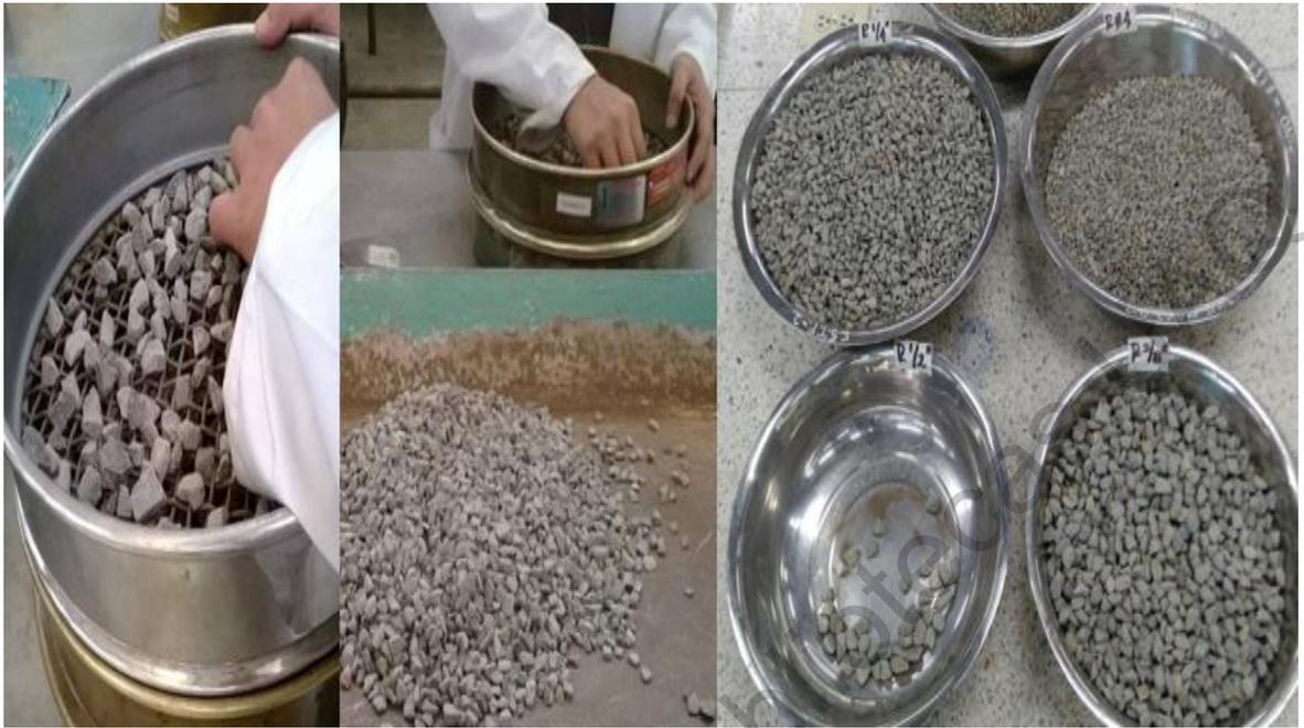
**Figura 3.2 Ensayo de distribución granulométrica del agregado grueso**
