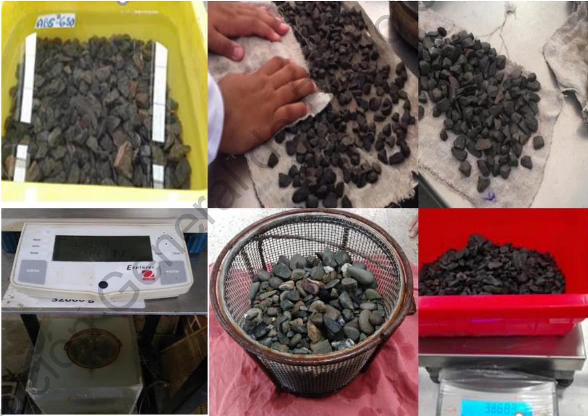
**Figura 3.6 Ensayo de densidad y absorción del agregado grueso**
