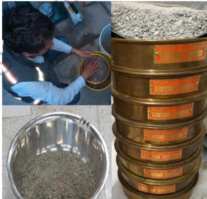
**Figura 3.7** Ensayo de distribución Granulométrica de Agregados Finos
