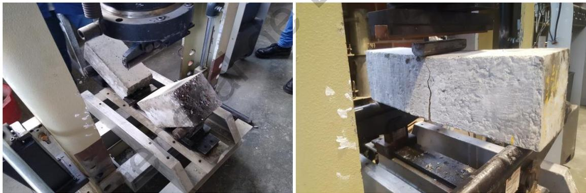
**Figura 4.4. Ensaye de muestra base (izquierda) y una de las reforzadas con geomalla de PET (derecha).**
