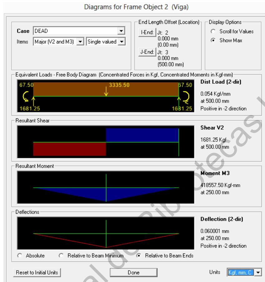
**Figura 4. 11. Diagramas de carga, cortante, momento y deflexión de la viga de concreto reforzado con geomalla de PET.**
