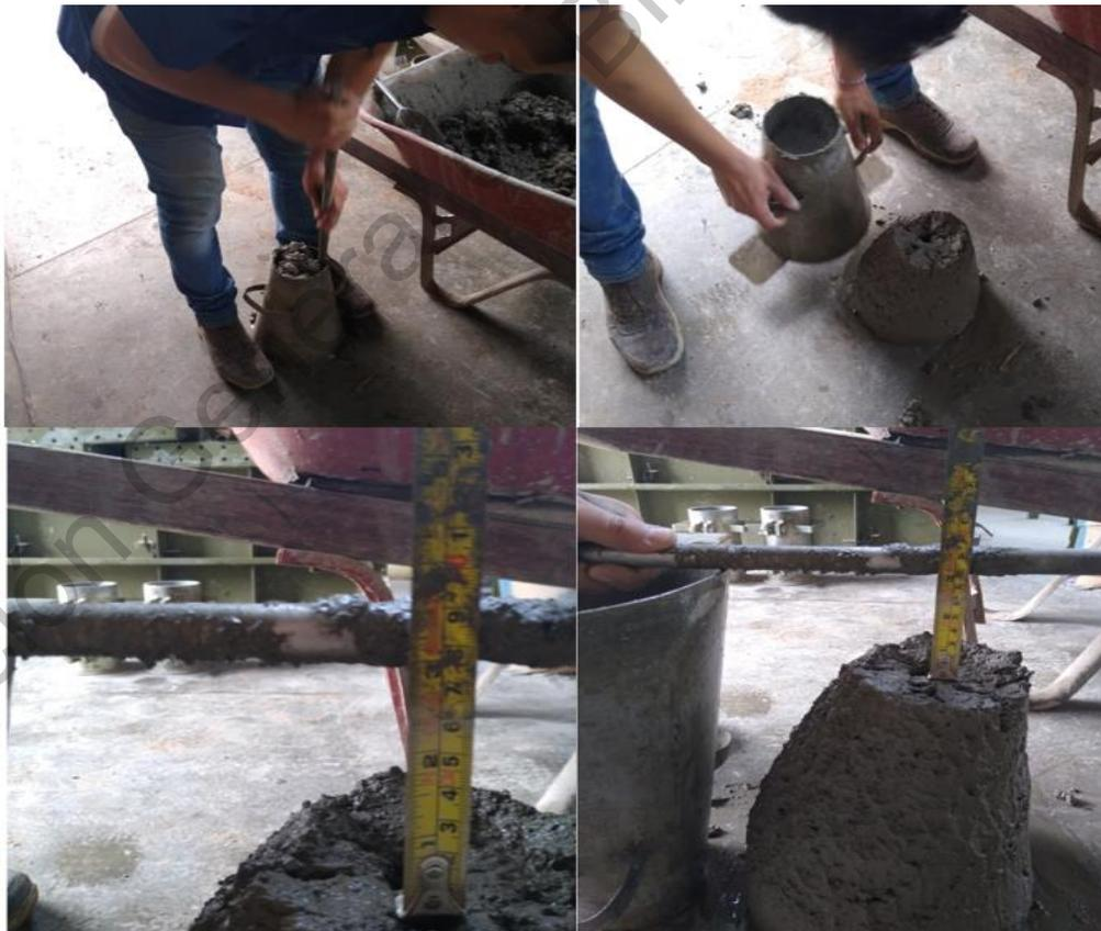
**Figura 3.13 Medición del revenimiento en el concreto**
