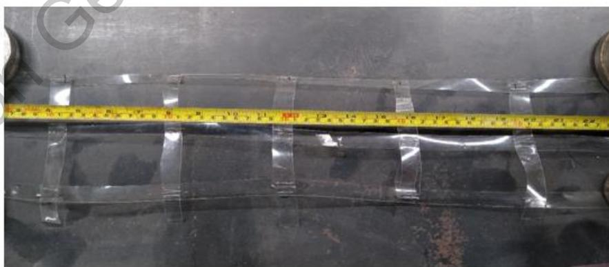
**Figura 4. 3. Comparación de la geomalla esperada (arriba) con la geomalla obtenida (abajo). Obsérvese la ondulación y curvatura de las tiras tratando de recuperar la forma cilíndrica de la botella.**
