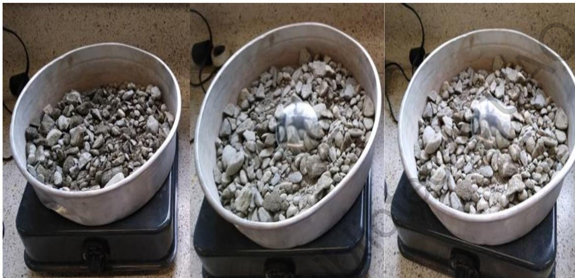
**Figura 3.5 Determinación del contenido de agua del agregado grueso**
