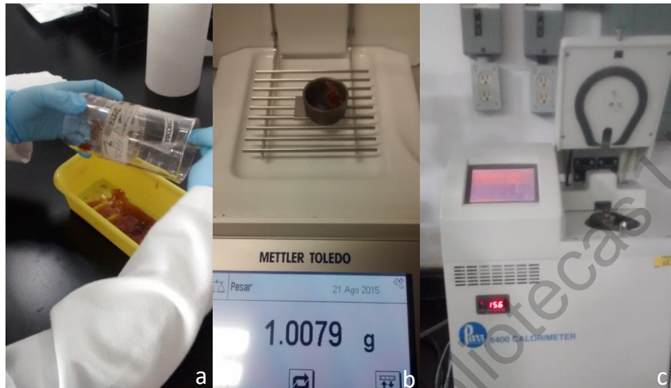
Figura 13. Calorímetro Isoperibólico usando para determinar el aporte calórico de las mermeladas Ramos 2007.
