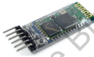
Figura 15. Módulo Bluetooth modelo HC-05 (HC05, 2020).
