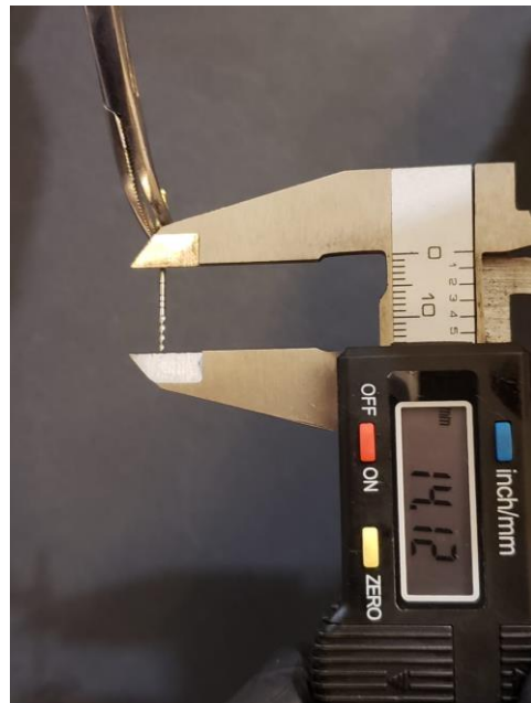
Figura 3. Realización de la prueba a la fatiga cíclica en platina de acero inoxidable.
