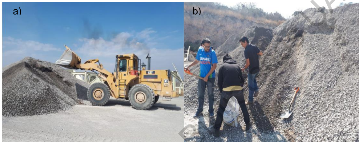
Figura 3.5 Muestreo del agregado pétreo. a) Mezclado del material pétreo, b) Recolección del material pétreo.
