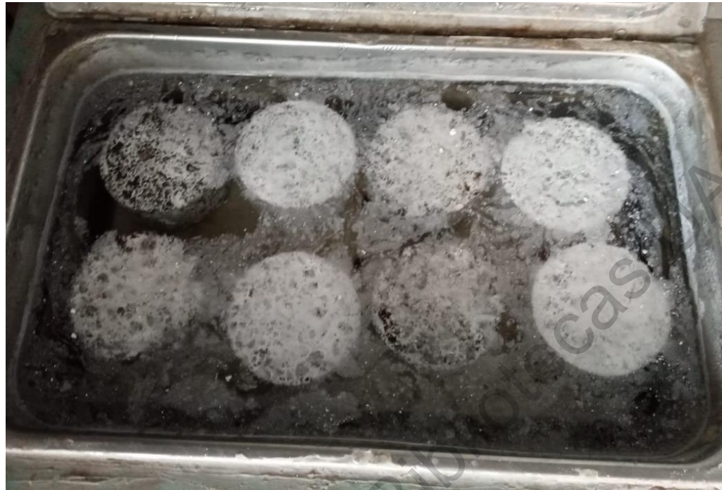
Figura 3.15 Pastillas en saturación a 60 °C.
