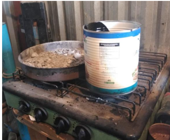
Figura 3.9 Calentado de material pétreo y asfalto en estufa.
