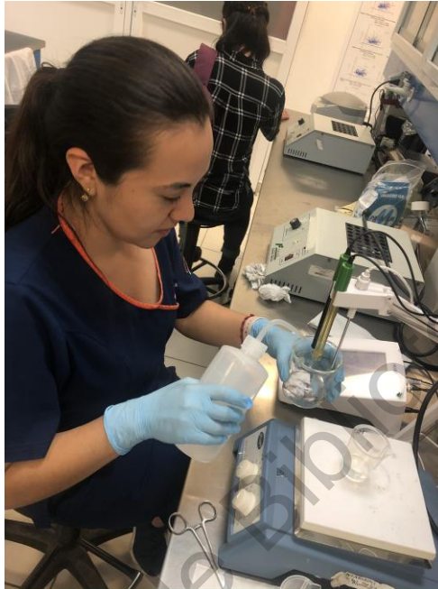
Fig. 4.2 Limpieza de los electrodos y sonda de temperatura con agua destilada
