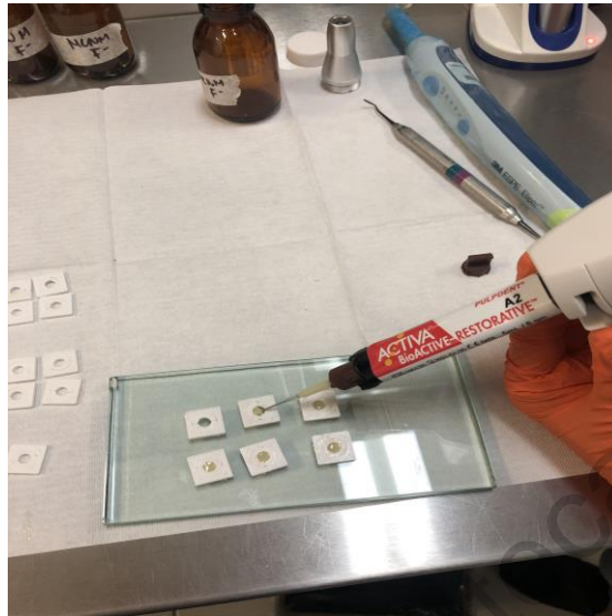
Fig. 3 Fabricación de muestra de resina 2mmx5 mm ACTIVA BioACTIVE.
