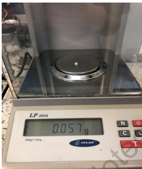
Fig. 3.2 Pesado de muestras en balanza analítica
