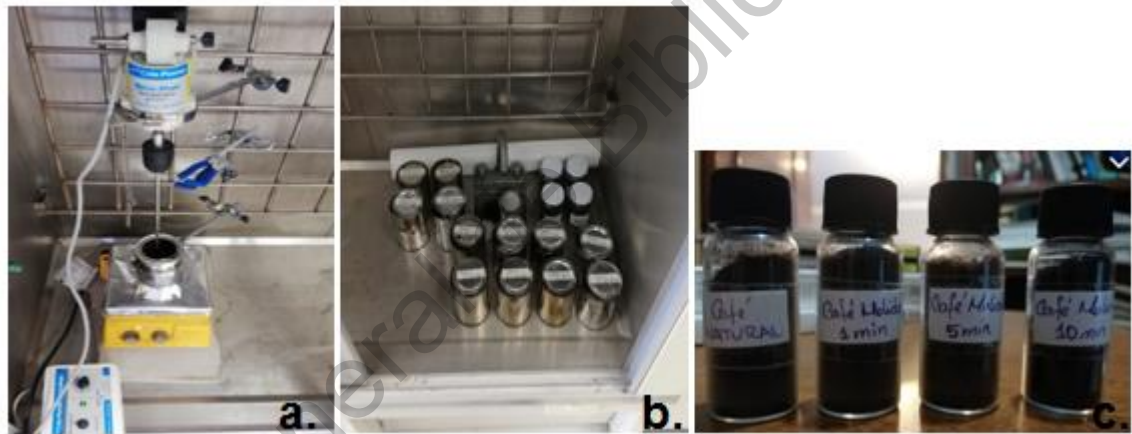
Figura 3. a. Equipo para el mezclado e incorporación del biomaterial café, b. Asfalto EKBE 64-22, c. Biomaterial, (Fuente elaboración propia, CFATA, UNAM)
