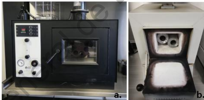
Figura 6. a. Horno Giratorio de Película Delgada, b. Tubos que portan el material a ensayar
