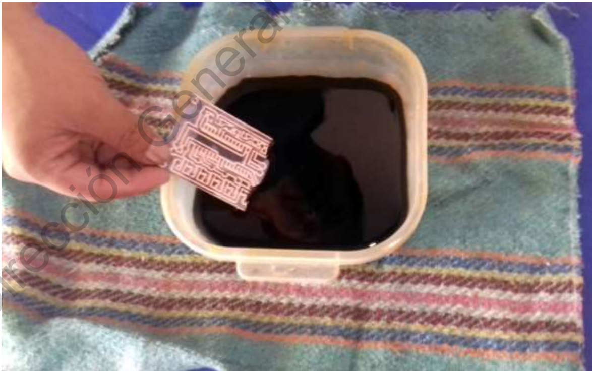
Figura 101. Introducir la placa en ácido.
