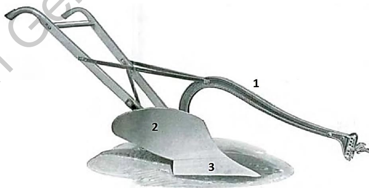
Figura 1-1. Elementos que componen el cuerpo de un arado 1) Bastidor 2) Vertedera 3) Reja (Rehkugler, 2011).
