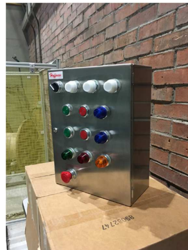
FIGURA 5.24 Sistema de control instalado en gabinete TTB2. a) Diseño asistido por computadora. b) Montaje físico de los elementos de control Fuente: Elaboración propia.
