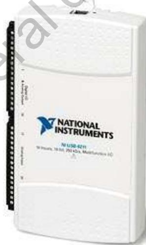
**Figura 3.4** Tarjeta National Instruments serie M modelo NI-USB 6211.
