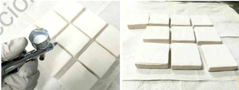
Figura 12: Aplicación de dióxido de titanio sobre las piezas muestra
