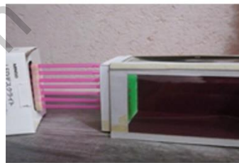
Conductos y caja de humo
