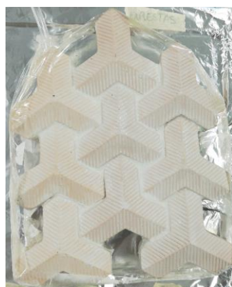
UNIÓN DE MÓDULOS CON CEMENTO BLANCO
