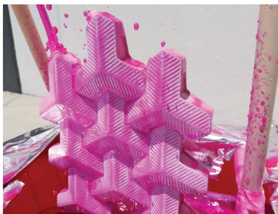
Figura 46: Sistema de reflujo fotocatalítico con rodamina B como indicador.
