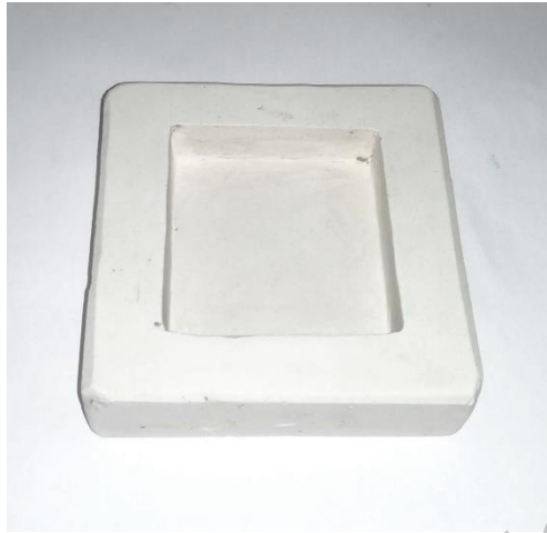
Figura 17: Molde de yeso para las diferentes piezas muestra
