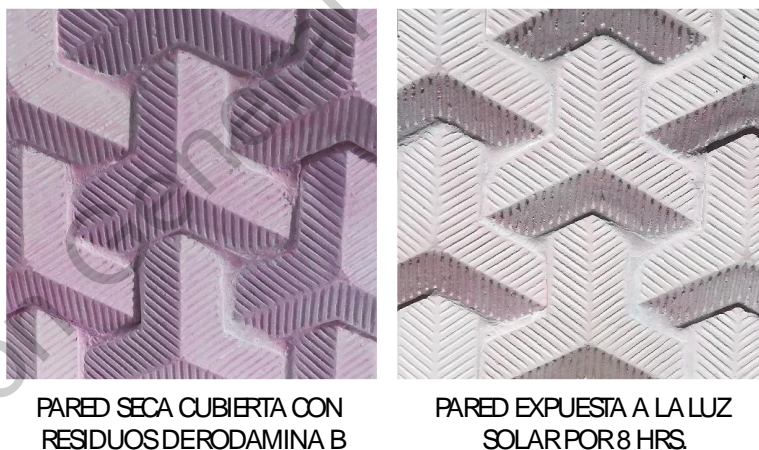
Figura 49: Registro de actividad purificante sobre la pared de módulos.
