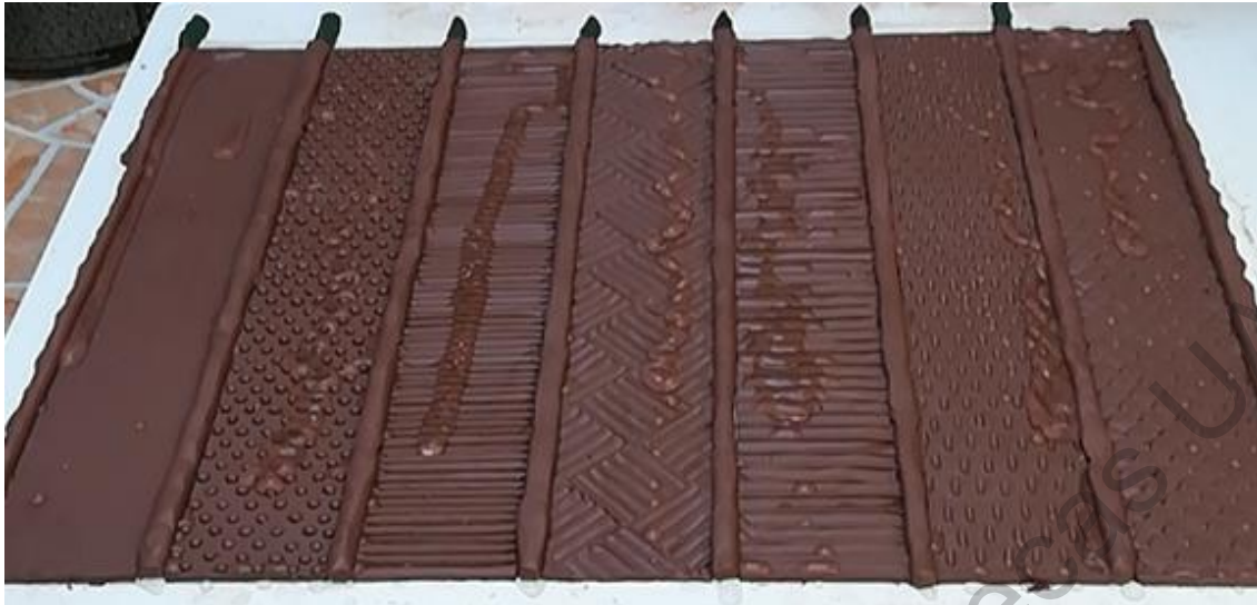
Figura 27: Comportamiento del caudal de agua sobre las diferentes superficies
