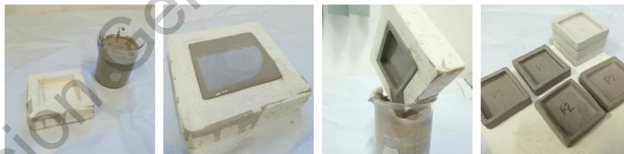
Figura 10: Vaciado de piezas muestra
