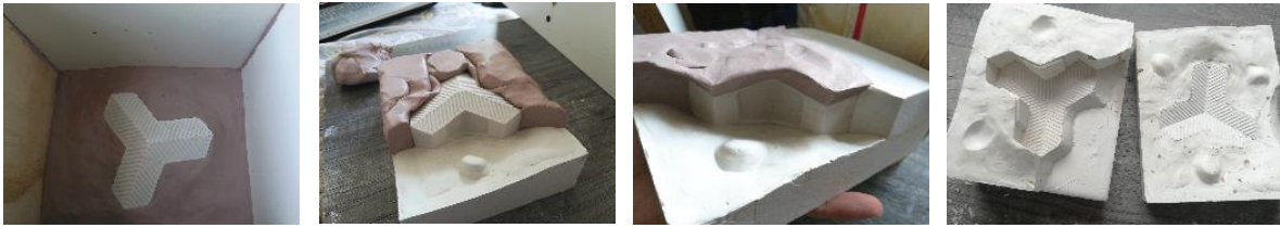
Figura 43: Construcción de molde de yeso para módulos cerámicos.
