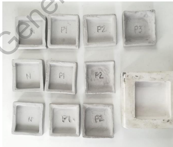
Figura 18: Piezas vaciadas antes de la sinterización
