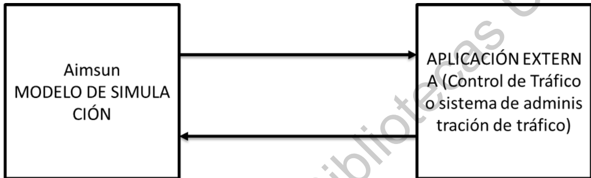
Figura 2-4. Esquema del funcionamiento de un control externo en AIMSUN.
