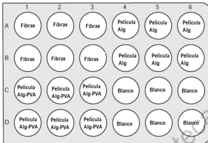
Figura 9. Diagrama de la distribución de los pozos para la prueba MTT, una placa para cada tiempo medido (Modificado de [44]).
