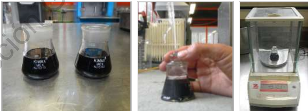
Figura 3-15. Ensayo de densidad en cemento asfáltico. FUENTE: Imagen capturada por el autor.
