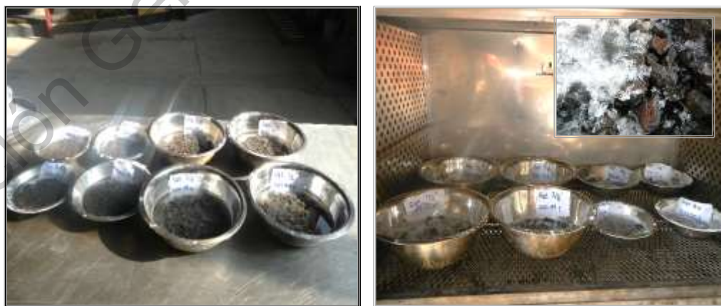
Figura 3-7. Ciclo de inmersión y secado de las muestras de agregado y formación de cristales.
