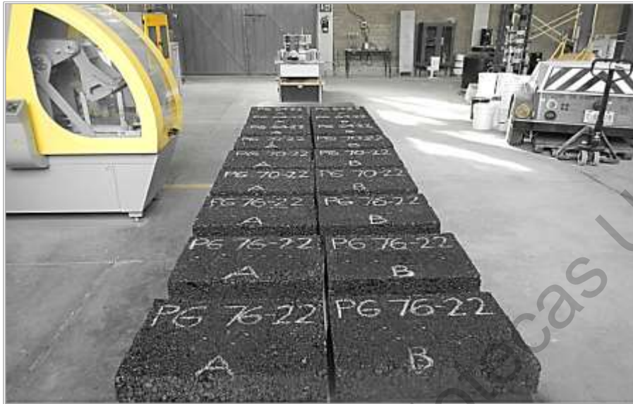
Figura 3-29. Total de placas fabricadas para extracción de vigas de prueba. FUENTE: Imagen capturada por el autor.
