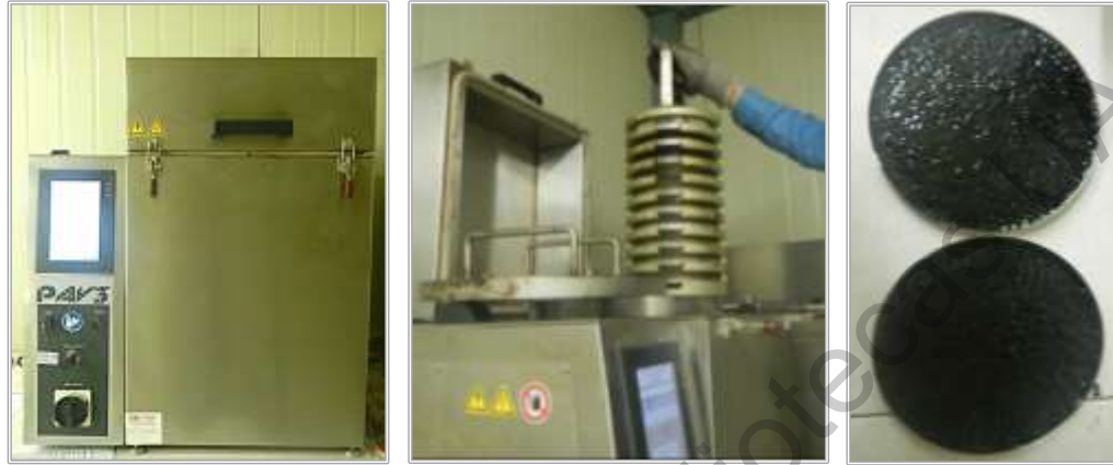
Figura 3-18. Equipo de envejecimiento a largo plazo y muestras de asfalto. FUENTE: Imagen capturada por el autor.
