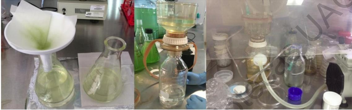
**Figura 9: Proceso de filtración: Cada muestra se filtró varias veces a fin de separar por tamaño celular a los microorganismos. A la izquierda se muestra la filtración inicial; en medio se presenta la filtración de 1.6 micras y finalmente, la filtración de 0.22 micras.**
