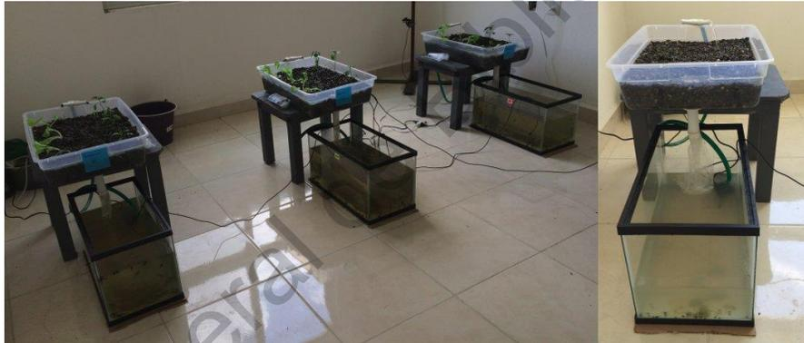
**Figura 6: Unidad experimental: estanque acuícola, biofiltro, sistema de recirculación de agua y sensores de monitoreo.**
