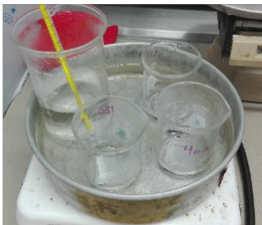
Figura 15. Pretratamiento de las placas de acero inoxidable con solución piraña en baño María.
