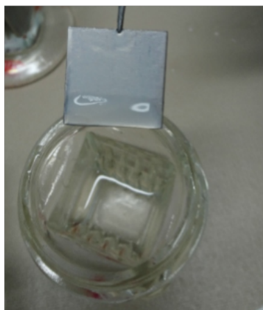
Figura 16. Placas de acero inoxidable después de la funcionalización con quitosano y el tratamiento con hidróxido de amonio.
