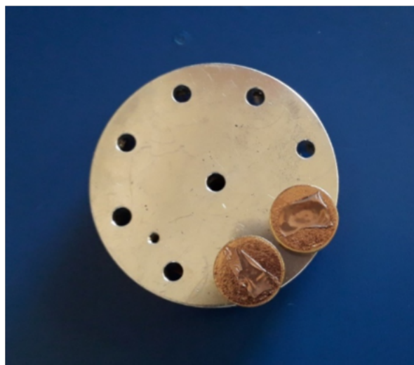
Figura 18. Preparación y recubrimiento con oro de las muestras a analizar por microscopia electrónica de barrido.
