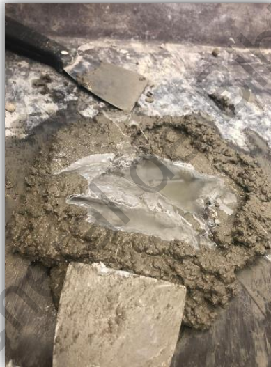
Figura ¡Error! No hay texto con el estilo especificado en el documento..29 Preparación de un cubo de mortero con EPS líquido.
