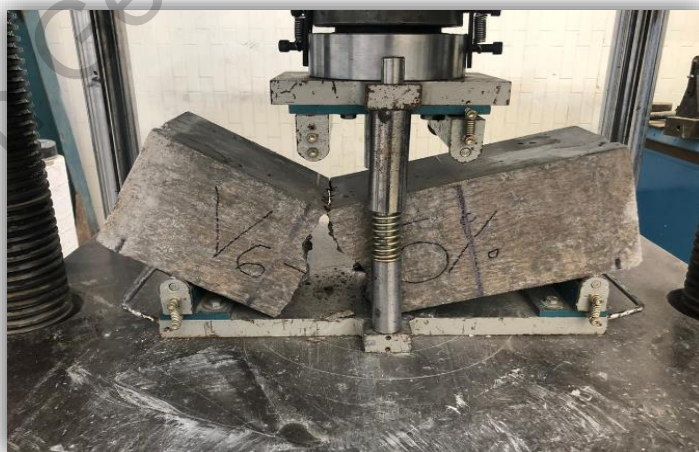
Figura ¡Error! No hay texto con el estilo especificado en el documento..25 Prueba de módulo de ruptura.
