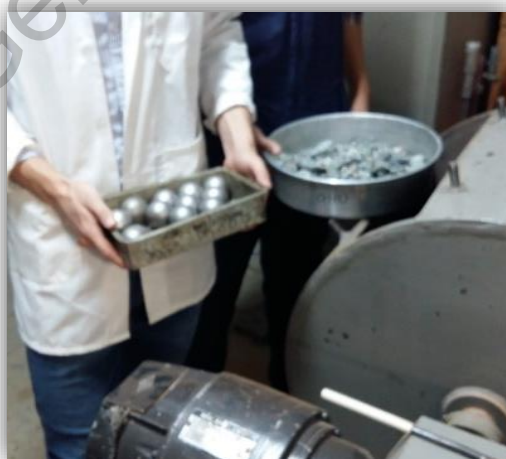
Figura ¡Error! No hay texto con el estilo especificado en el documento..20 Preparación de la prueba de desgaste de los Ángeles. Fuente: Elaboración propia.
