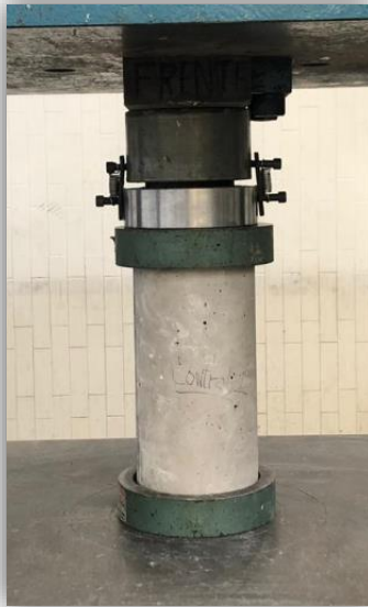
Figura ¡Error! No hay texto con el estilo especificado en el documento..23 Prueba de resistencia a la compresión. Fuente: Elaboración propia.
