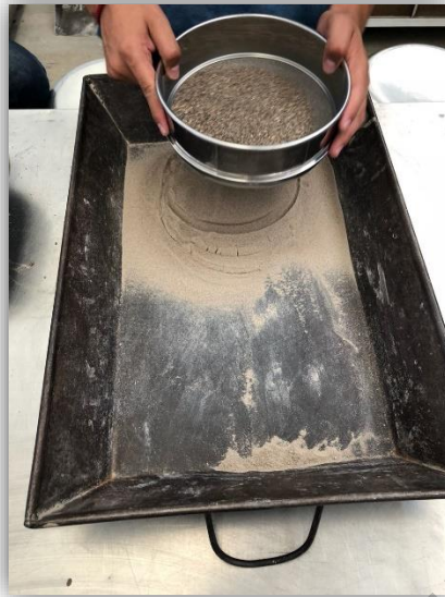
Figura ¡Error! No hay texto con el estilo especificado en el documento..16 Cribado de la fracción fina. Fuente: Elaboración propia
