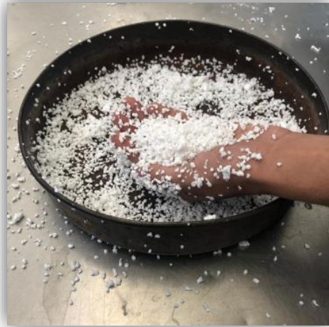
Figura ¡Error! No hay texto con el estilo especificado en el documento..22 Partículas homogéneas de EPS. Fuente: Elaboración propia.
