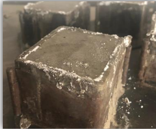
Figura ¡Error! No hay texto con el estilo especificado en el documento..30 Cubo de mortero con EPS líquido. Fuente: Elaboración propia.
