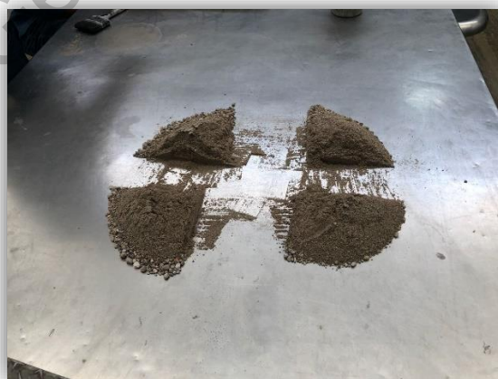
Figura ¡Error! No hay texto con el estilo especificado en el documento..13 Cuarteo de una porción del agregado fino.
