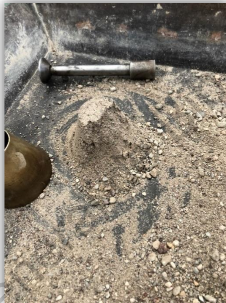
Figura 3.6 Condición saturada superficialmente seca del agregado fino.
