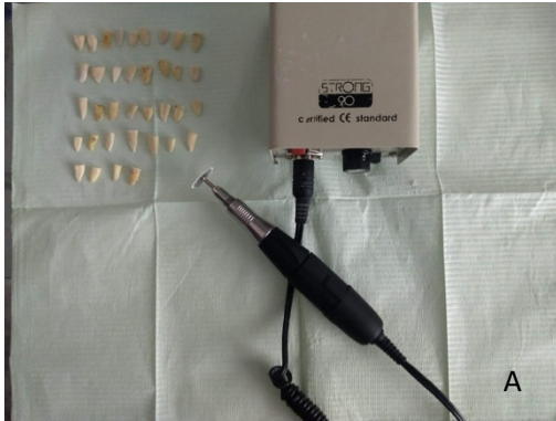
Figura 1. Preparación de especímenes, A. Corte en sentido transversal de los dientes con la ayuda de micromotor y disco de diamante para dejar solo la porción radicular. B. Patentización y longitud de trabajo de espécimen.
